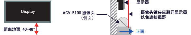
FIG. 4 ACV-5100 壁挂式安装注意事项
