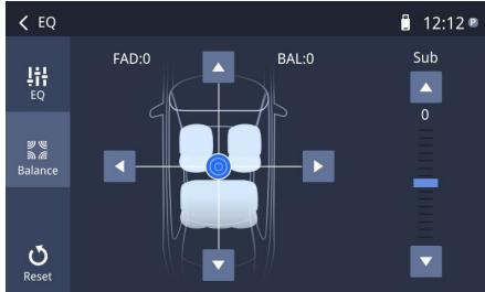
Ajuste el fader y el balance con [ ▼ ]/[ ▲ ] o [◀]/[▶].
