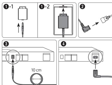
Consulte a imagem e conecte o MICRO LED e a One Connect Box com o cabo da One Connect fornecido como componente.
