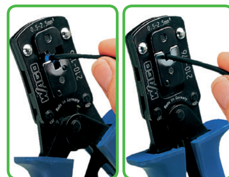
Leiter mit Stiftkabelschuh in Crimp-Position einführen und während des Crimp-Vorganges festhalten.
