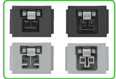
Steckverbinder der Kodierung B (hier in der Farbe Grau dargestellt) unterscheiden sich nicht nur farblich, sondern auch im mechanischen Design und sind somit mit keiner anderen Kodierung steckkompatibel.
