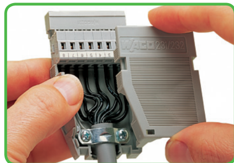
Aufrasten des Zugentlastungsoberteils am Beispiel einer Stiftleiste. Kabelabgang längs. Zugentlastung durch Kabelschelle.
