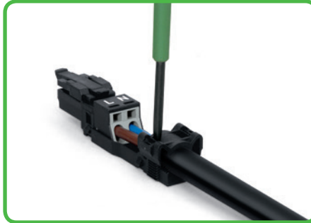
Zugentlastungsschelle mit Schraubendreher, Klingbreite 2,5 mm, auf beiden Seiten wechselseitig herunterdrücken.
