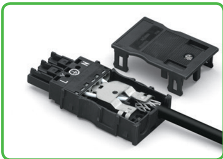
Verdrahteten Steckverbinder in Zugenlastungsgehäuse einlegen, mit Oberteil zusammenfügen und festschrauben.
