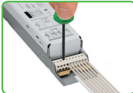
Leiter lösen - Lösewerkzeug in Löseöffnung stecken und Leiter herausziehen.
