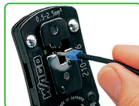
Crimp-Zange bis über den Rastpunkt zusammenpressen und Leiter mit angecrimptem Stiftkabelschuh entnehmen.
