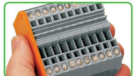
Spritzkolben jeweils so weit hinunterdrücken, bis Alu-Plus die Öffnungen gefüllt hat.
