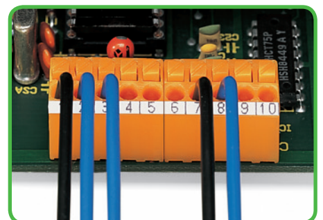
Aneinanderreihen von Klemmenblöcken ohne Polteilungsverlust.
