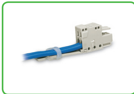
Zugentlastungsplatte, werkseitig montiert, Federleiste, Rastermaß 2,5 mm, lichtgrau, 2-polig mit Zugentlastungsplatte 733-102/032-000 .
