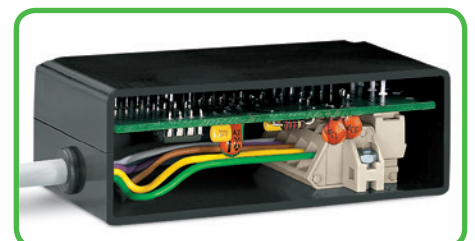
Frei montierte Steckverbindung. Hier Stiftleiste mit CAGE CLAMP®-Anschluss und Zugenlastungsplatte als Abgang.
