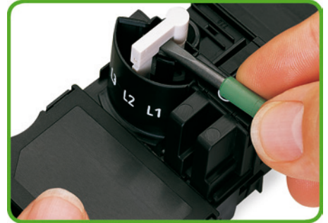
Den Schaltbrücker aus der Lieferposition (L2) mittels Schraubendreher heraushebeln und in die gewünschte Position drehen.
