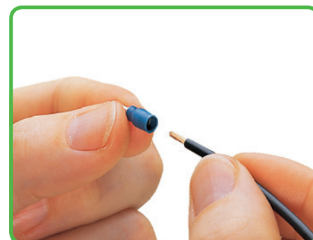
Passenden Stiftkabelschuh auf den Leiter stecken.
