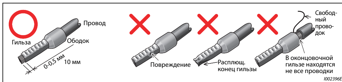
Рис. 2-32: Опрессовка оконцовочной гильзы
