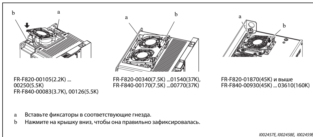
Рис. 7-6: Монтаж крышки вентилятора
