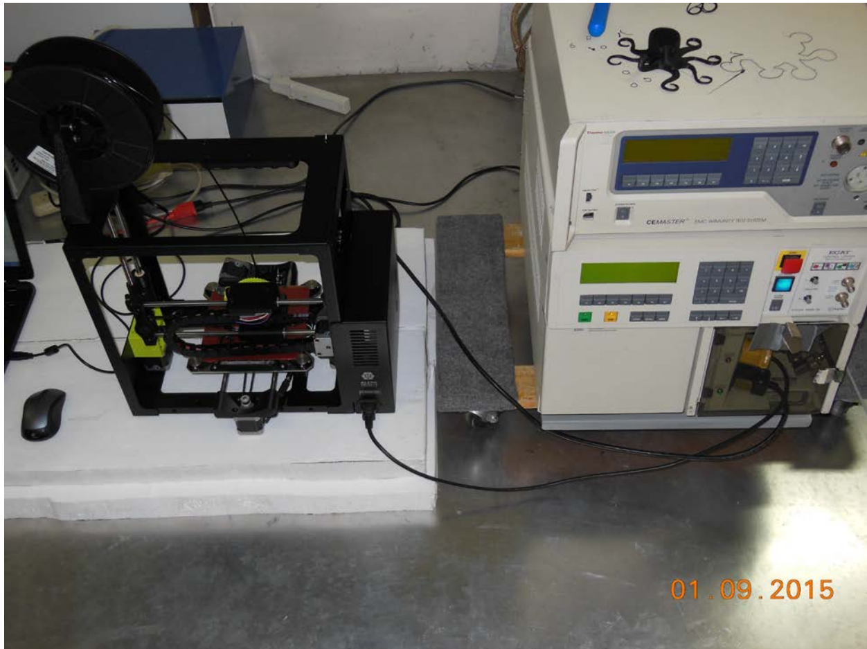
Test Setup per EN 61000-4-4
