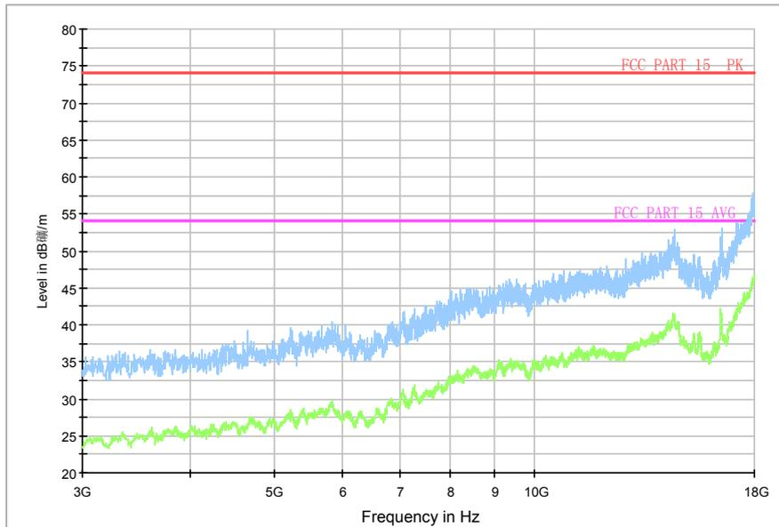
Fig.73. Radiated emission:  $\pi/4$  DQPSK, Channel 39, 3 GHz - 18 GHz
