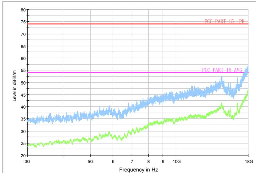
Fig.75. Radiated emission:  $\pi/4$  DQPSK, Channel 78, 3 GHz - 18 GHz
