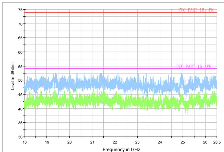
Fig.78. Radiated emission:  $\pi/4$  DQPSK, 18 GHz - 26 GHz
