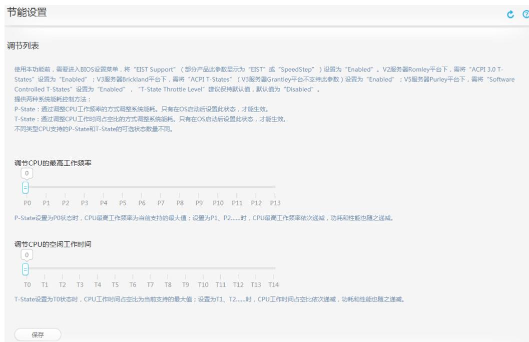
图 3-19 其他机架服务器的“节能设置”界面
