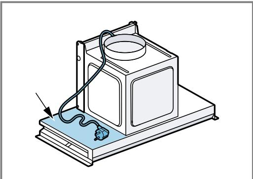
2. Σπρώξτε τη συσκευή το λιγότερο μέχρι τη μέση στις ράγες ① και οδηγήστε το φίς μέσα από το άνοιγμα ②.
