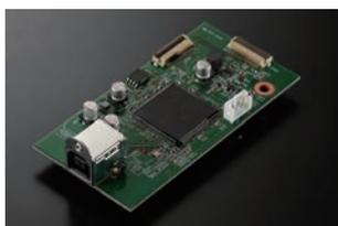
最新のデジタル回路を採用しているD-03Xには、MQAデコーダー基板を搭載したことでMQA(MQA-CD/MQAファイル)のフルデコード再生に対応。さらにUSB入力はPCM 384kHz/32bit、DSD 11.2MHz/1bitまで対応しており、最先端のファイル再生が可能です。
