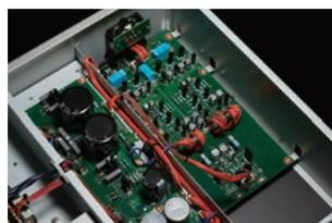
D-03Xでは、モノラルモードで動作させたD/Aコンバーターの差動出力を、完全バランス構成のI/V変換回路のアンプ基板に入力し、ローインピーダンス化させることで次段ローパス・フィルターアンプを強力に駆動できます。
