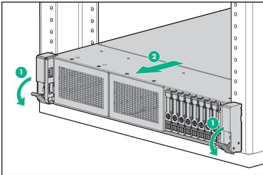
4. 本機を手前にスライドさせしっかりと持ってラックから取り外します。途中で本機がロックされたら、引き続き、レール側面にあるレールストッパーを押し、ゆっくりと引き出し本機を取り出し、ラックから取り外します。
