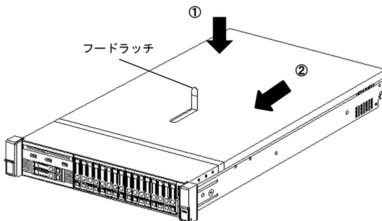
2. フードラッチを押し下げます。トップカバーが完全に閉まるまでスライドさせます。
