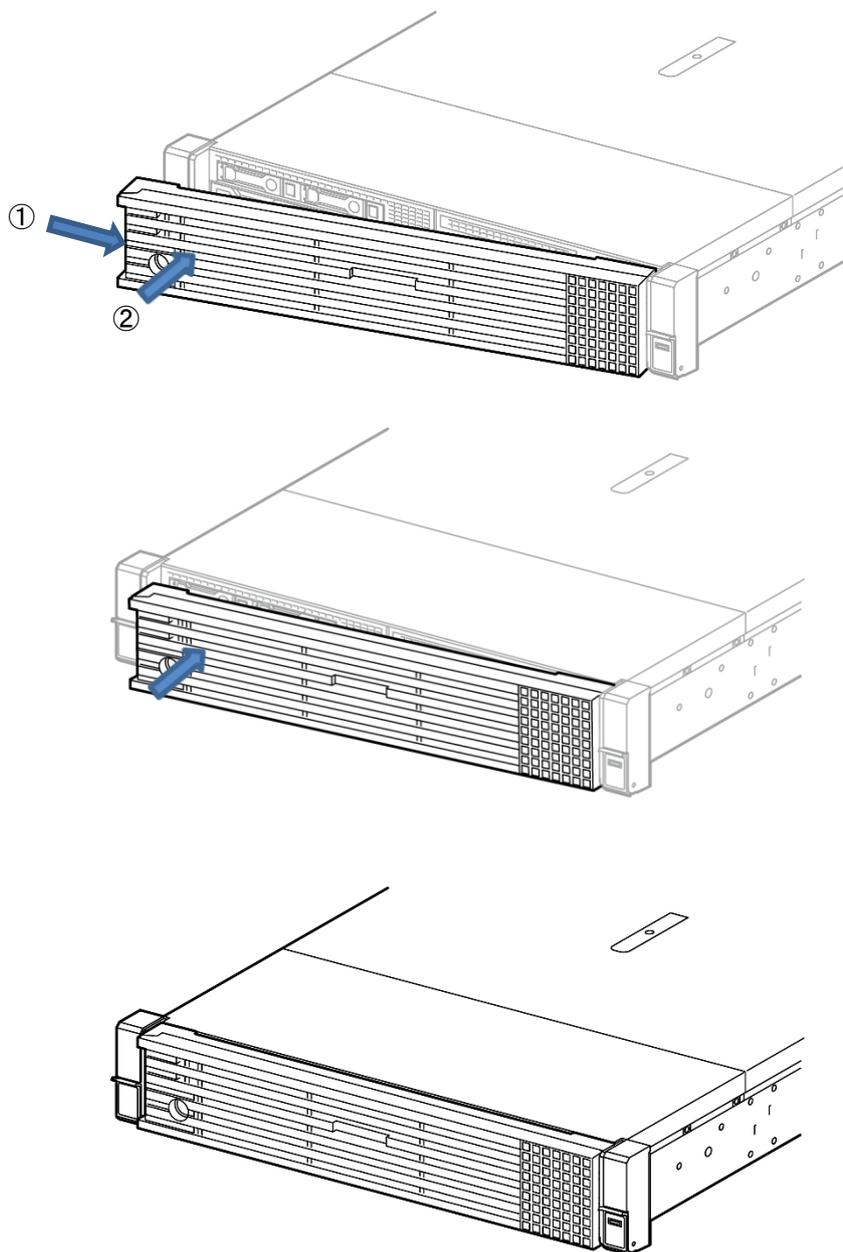
3. キーを差し込み、押しながら右方向に回してロックをかけます。
