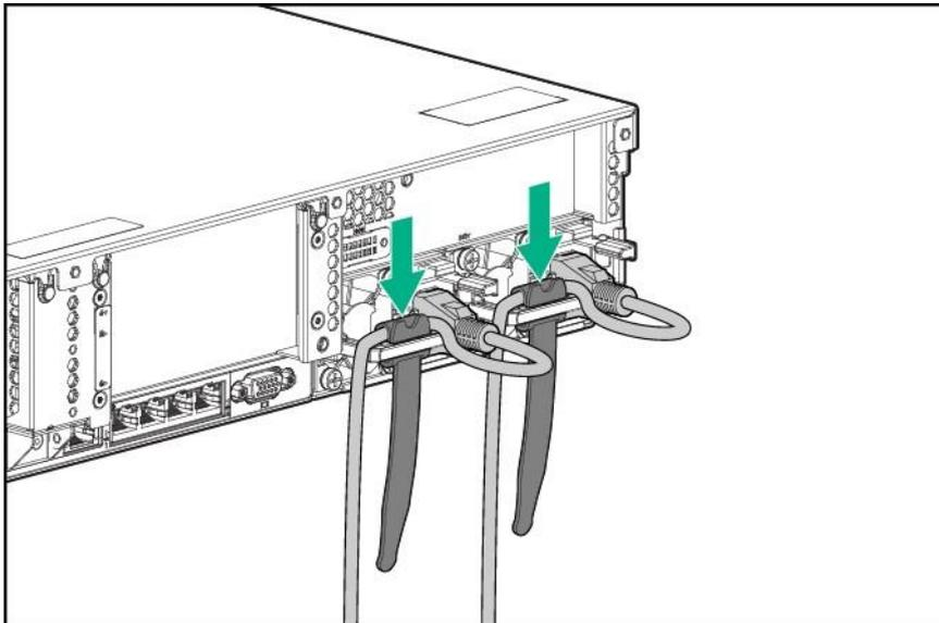
2. ラックの裏側にケーブルマネジメントアームの固定部分2か所をアウターレールとインナーレールに挿し込みます。
