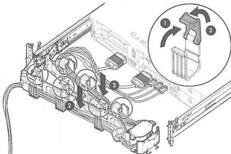
3. ケーブルマネジメントアームの反対側の固定部分2か所のロック解除ボタンを押しロックを外してから手前に引き抜きます。
