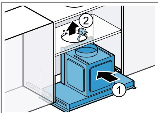
3. Полностью задвиньте прибор в шкаф.
