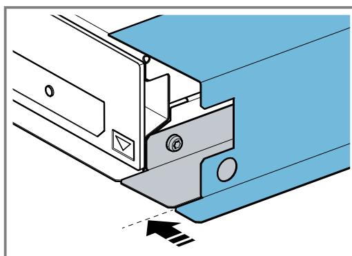
3. Для шкафов глубиной от 330 мм до 360 мм (внешний размер) установите компенсатор глубины воздуховода.
