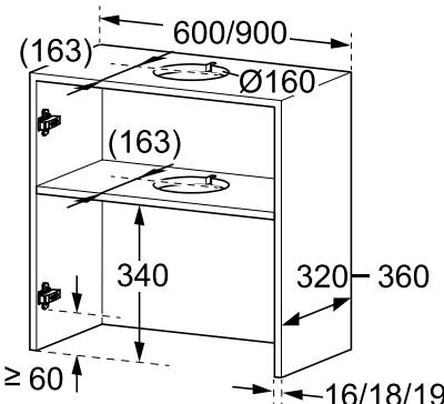
4. Выполните вырез для вытяжной трубы в промежуточных полках шкафа.
