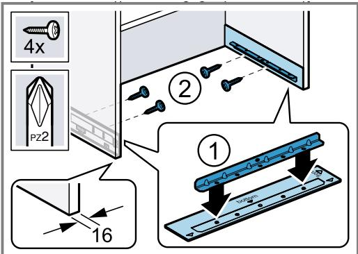
9. Для толщины стенок от 18 до 19 мм: прикрутите направляющие без монтажного приспособления.
