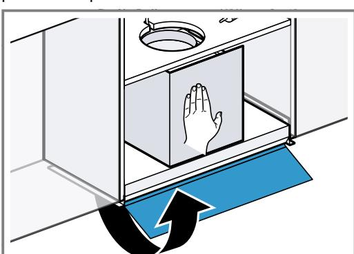
7. **Заметка:** Убедитесь, что передняя стенка прибора не выступает за переднюю стенку шкафа после привинчивания прибора.
