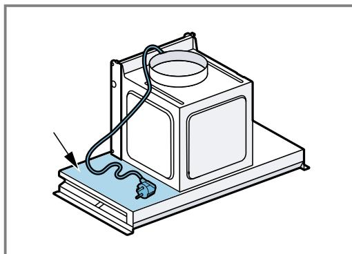
2. Задвиньте прибор в направляющие как минимум наполовину ① и проденьте вилку кабеля питания в вырез ②.
