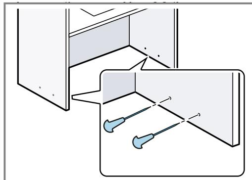
8. Для толщины стенок 16 мм: установите направляющие на монтажные приспособления ① и прикрутите их к боковым стенкам шкафа ②.
