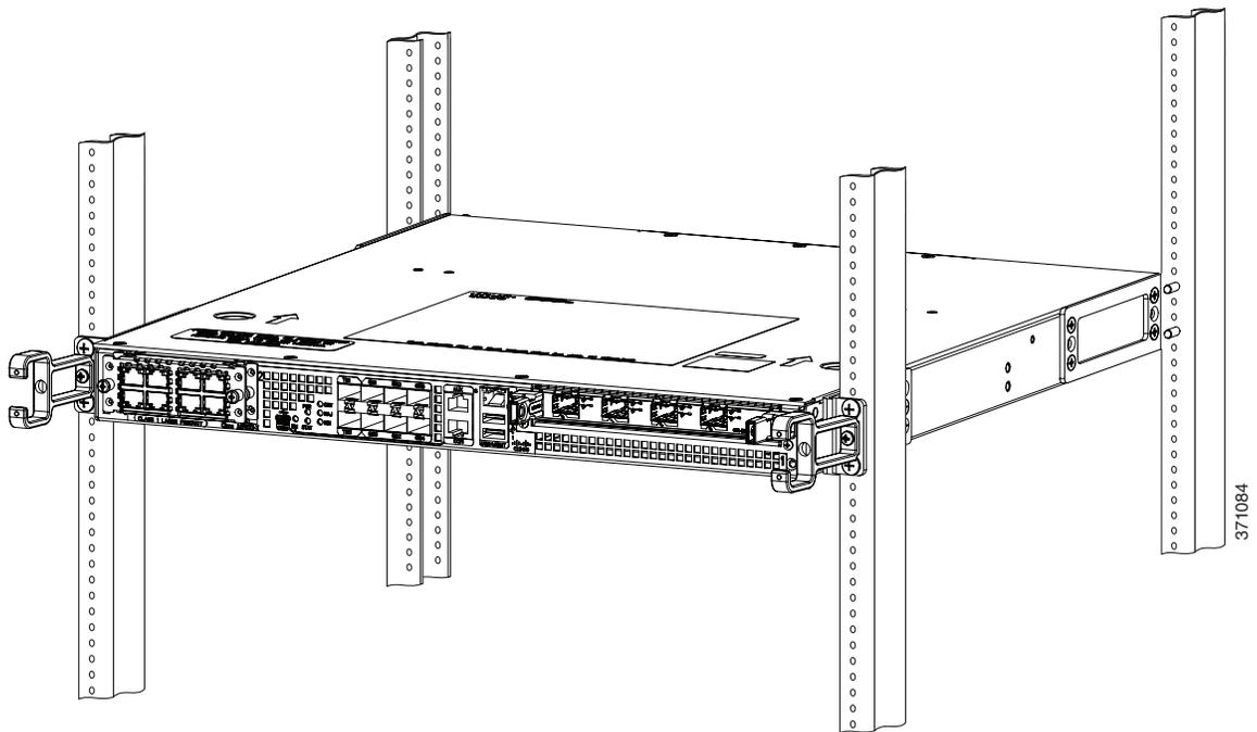
**ステップ 6** 水準器を使用して 2 つのブラケットが同じ高さにあることを確認します。または、巻き尺を使用して両方のブラケットがラックレールの上から同じ距離であることを確認します。
