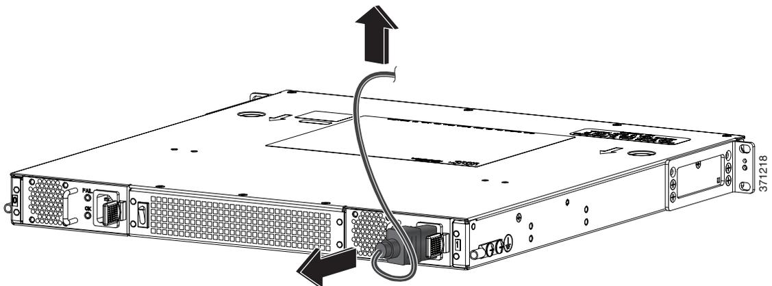
図 7-2 AC 電源モジュールの取り外し
