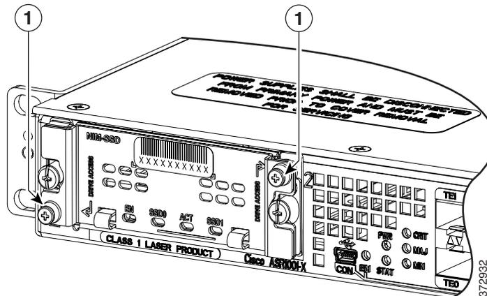
1. SSD ドライブを NIM キャリア カードに取り付けている SSD スロット カバーの非脱落型ネジ
