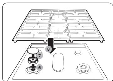
7. Vuelva a colocar las tapas de los quemadores en sus posiciones arriba de los cabezales. Para garantizar un funcionamiento correcto y seguro, asegúrese de que las tapas de los quemadores queden planas arriba de los cabezales.
