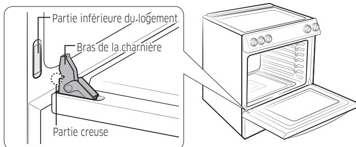
3. Ouvrez la porte au maximum. Si la porte ne s'ouvre pas complètement, c'est que les parties creuses ne sont pas correctement insérées dans les parties inférieures de chaque logement.
