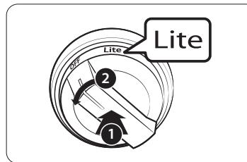
Asegúrese de que todos los quemadores superiores estén correctamente instalados. Para encender un quemador:
