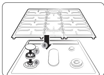
7. Repositionnez les chapeaux des brûleurs au-dessus des têtes des brûleurs. Pour garantir un fonctionnement correct et en toute sécurité, assurez-vous que les chapeaux des brûleurs portent à plat au-dessus des têtes de brûleurs.
