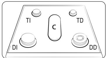
Cada quemador tiene una perilla correspondiente que le permite ajustar el nivel de la llama de LO (Bajo) a HI (Alto). Además, cada perilla tiene un ajuste Lite (Encender). Al girar la perilla hacia la posición Lite (Encender), se enciende el quemador correspondiente. Los indicadores de los quemadores están situados sobre cada perilla y muestran qué quemador controla dicha perilla. Cada quemador está diseñado para un propósito de cocción específico. Consulte la tabla a continuación.
