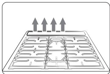
Les orifices de ventilation du four et de refroidissement se trouvent à l'arrière du four de la cuisinière. Une circulation d'air correcte évite les problèmes de combustion et garantit de meilleures performances.
