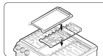
El comal se puede utilizar solo con el quemador central en la rejilla central. Tenga cuidado al colocar el comal en la rejilla central.
