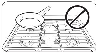
Coloque los recipientes en el centro de la rejilla. No coloque un recipiente con un diámetro superior a 9" en los quemadores traseros. Si coloca un recipiente de mayor tamaño en la posición incorrecta, podría interrumpir la circulación de aire necesaria y hacer que la llama del quemador chisporrotee y queme de manera ineficiente.
