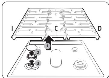
1. Retire la rejilla del quemador central (C) siguiendo las rejillas laterales (I/D).
