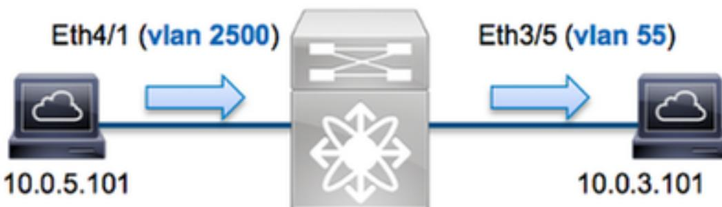
在本例中，在VLAN 2500的一台主机(10.0.5.101)，端口Eth4/1发送互联网控制消息协议(ICMP)请求到在VLAN 55的一台主机(10.0.3.101)，端口Eth3/5。 伊拉姆用于为了获取从10.0.5.101的此单个数据包到10.0.3.101。请记住伊拉姆允许您捕获单个帧。
