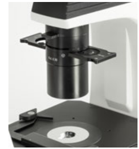
N.A. 0,3 Abbe Condenser with phase contrast slide
