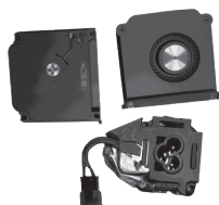
Ventiladores y toma de corriente
