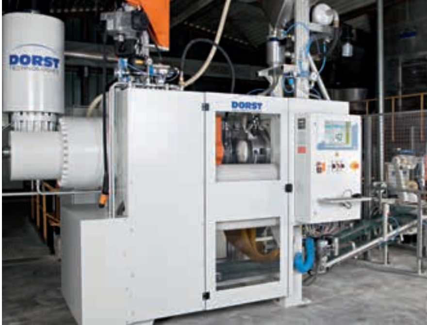
▲ Individuelle Lösungen, modular aufgebaut: Isostatisches Fertigungssystem Dorst PH 450 mit Bearbeitungsstationen zur Herstellung von Flachgeschirren und Schüsseln unterschiedlichster Konturen.
