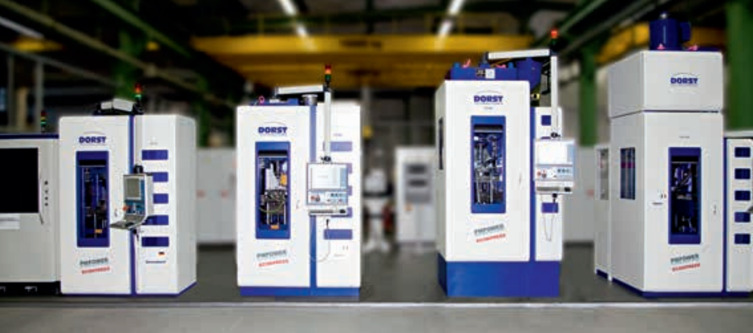
▲ Baureihe EP von Dorst: Die neue Generation servomotorischer Pulverpressen mit einer Presskraft von 150 kN bis 1.600 kN.
