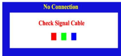
Såfremt en boks ikke kommer til syne betyder det, at der er et problem med din monitor. Denne boks kommer også frem under normal drift, hvis videokablet går løst eller bliver ødelagt.
