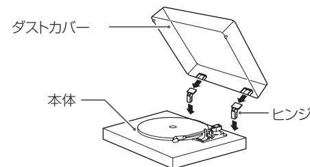
**1** 本体背面の左右両端にあるヒンジ差し込み部にヒンジを合わせて、奥まではめ込みます。
