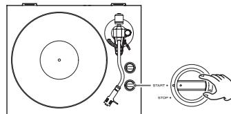
回転つまみ (START/STOP) を「START」の位置にすると青色の START ランプが点灯してターンテーブル (プラッター) が回転します。
