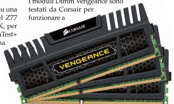
1.866 MHz con temporizzazioni 9-10-9-27. I parametri operativi programmati nel chip Spd sono invece relativi alla frequenza operativa nominale di 1.333 MHz con temporizzazioni 9-9-9-24. La tensione di alimentazione prevista per queste memorie è di 1,5 volt.
