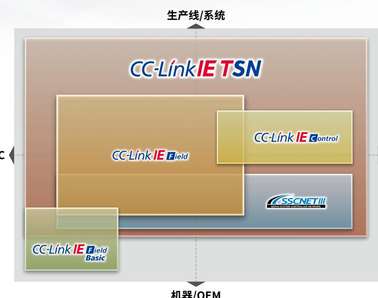
CC-Link IE TSN, is继承了CC-Link IE Field Network的易诊断性，CC-Link IE Control Network的大容量通信和SSCNET的高性能运动控制所代表的特点，重新定义了通信协议，并采用了TSN技术的全新的工业用开放式网络。CC-Link IE TSN通过采用TSN技术，在成为更为开放式的工业用网络的同时，通过高效的通信协议，更加强化了以往的网络所具有的性能和功能。
