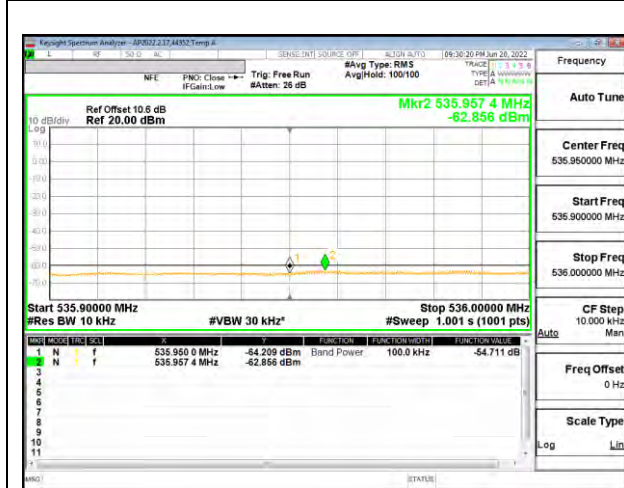
MID CHANNEL Antenna 2 Lower Edge
