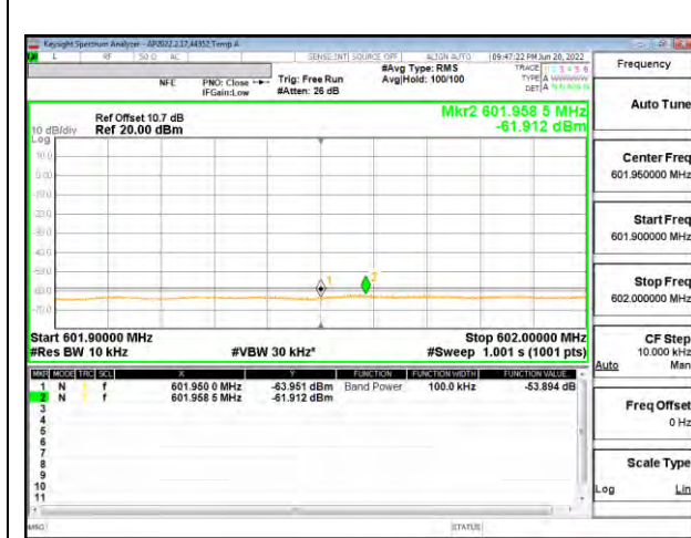
HIGH CHANNEL Antenna 2 Lower Edge
