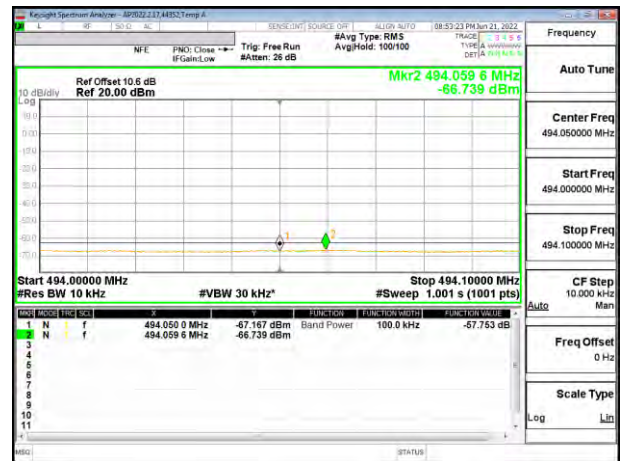
LOW CHANNEL Antenna 2 Upper Edge
