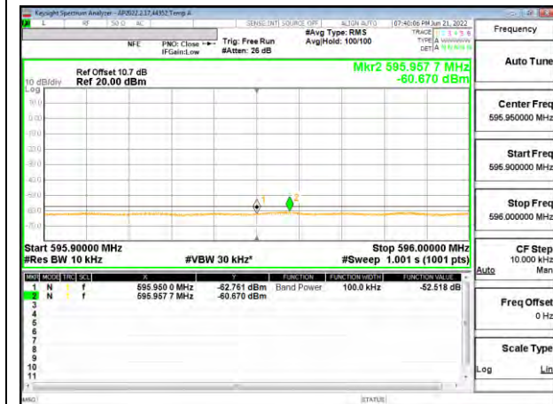
HIGH CHANNEL Antenna 2 Lower Edge
