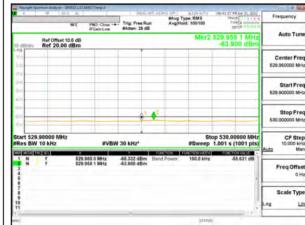
MID CHANNEL Antenna 1 Lower Edge
