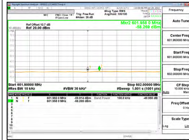
HIGH CHANNEL Antenna 1 Lower Edge
