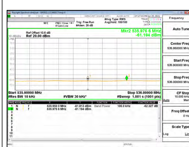
MID CHANNEL Antenna 1 Lower Edge
