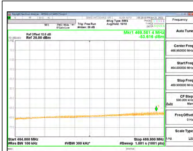
LOW CHANNEL Antenna 1 Lower Edge
