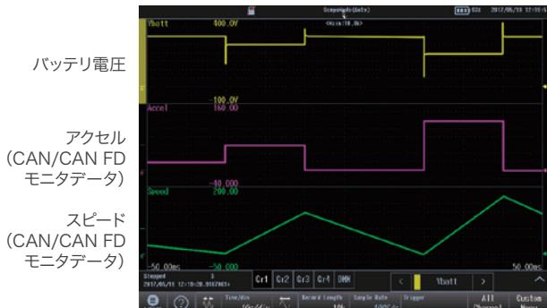
表示例（アクセル変化に対する車体スピードとバッテリ電圧の変動を表示）
