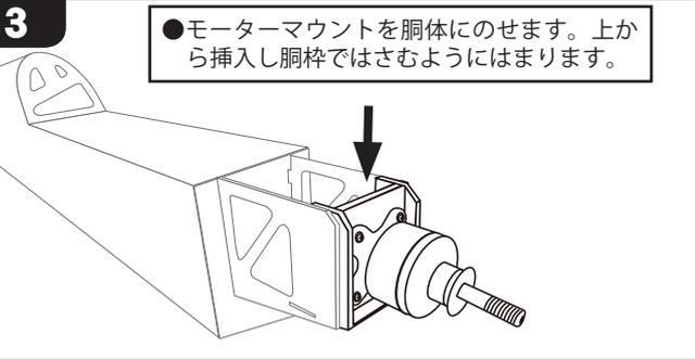
●モーターマウントを胴体にのせます。上から挿入し胴枠ではさむようにはまります。
