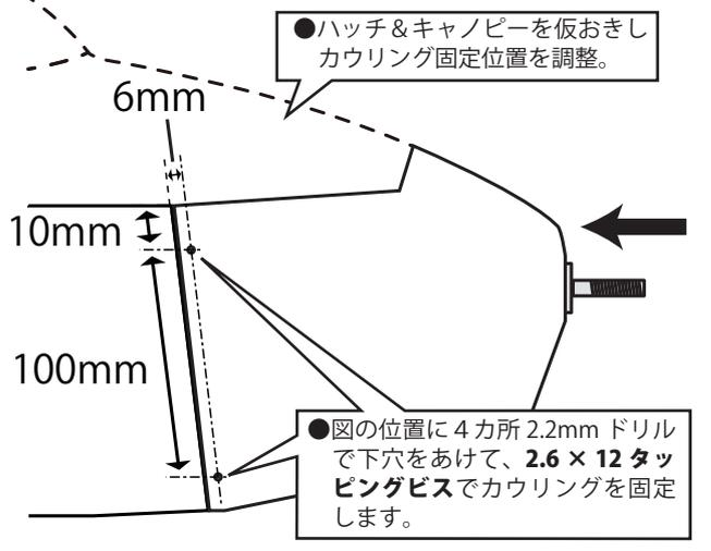
●ハッチ&キャノピーを仮おきしカウリング固定位置を調整。
