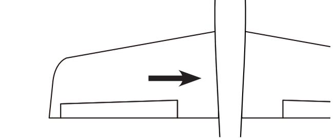
**!** カーボンカンザシの主翼への挿入ですが、湿度や温度により入りにくい場合があります。ムリに押しこんだり、斜めに挿入すると、主翼の部品が破損しますので、注意してください。
