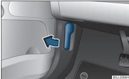
Изобр. 178 Рычаг для расфиксирования запора капота двигателя
