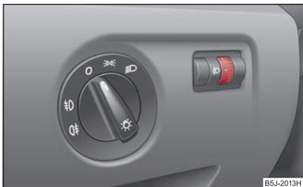
Изобр. 51 Панель приборов: регулирование угла наклона фар
