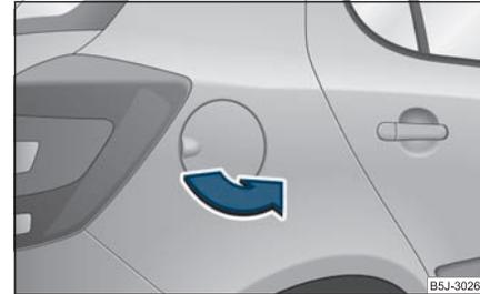
Изобр. 176 Боковая сторона автомобиля направо сзади: откидная крышка заливной горловины топливного бака
