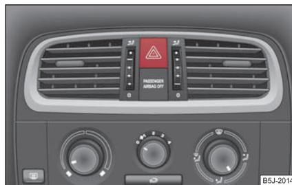
Изобр. 52 Панель приборов: выключатель для системы аварийной световой сигнализации
