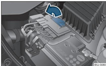
**Изобр. 186** Аккумуляторная батарея: откидывание чехла (механическая коробка передач)
