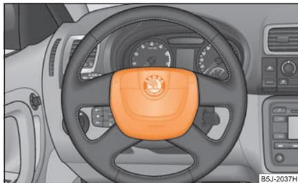
Изобр. 148 Надувная подушка безопасности для водителя в рулевом колесе
