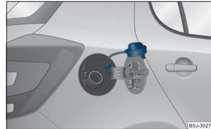
Изобр. 177 Откидная крышка заливной горловины топливного бака с отвинченной резбовой пробкой
