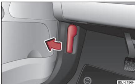
Изобр. 14 Рычаг для расфиксирования запора капота двигателя
