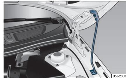
Изобр. 180 Зафиксированное состояние капота двигателя опорой
