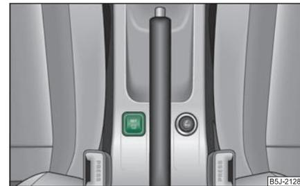
Изобр. 171 Выключатель для настройки опорного значения для контроля давления воздуха в шинах
