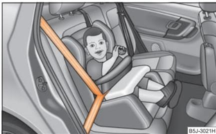
Изобр. 162 Специальное сиденье для ребенка категории 1 с предохранительным столиком на заднем сиденье по направлению движения автомобиля
