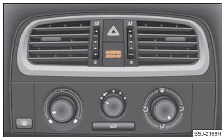
Изобр. 157 Сигнализатор выключенной надувной подушки безопасности Airbag для пассажира переднего сиденья
