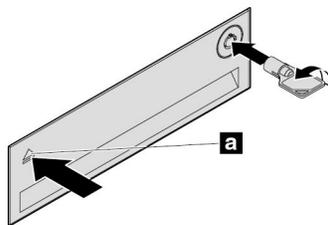
图 15. 打开前置式存储机箱外盖
