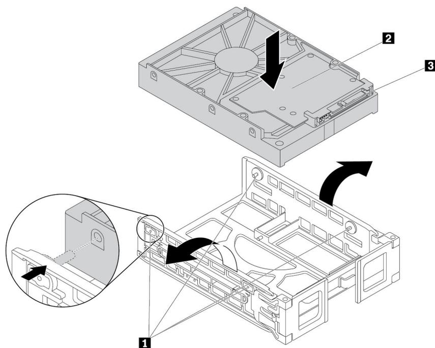
图 62. 将存储驱动器装入类型 **1** 支架中
