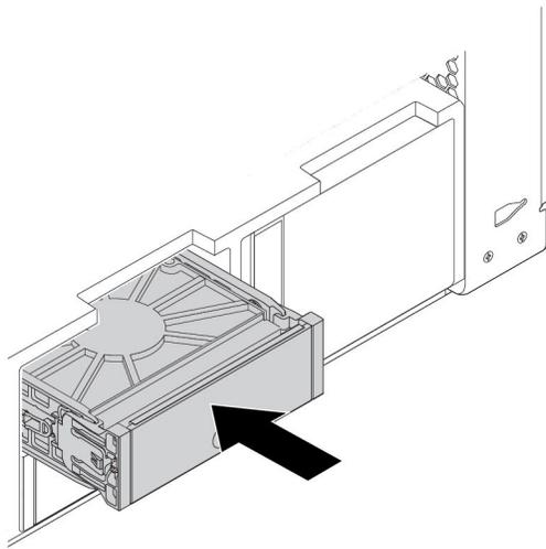
图 67. 安装类型 **2** 存储驱动器支架
