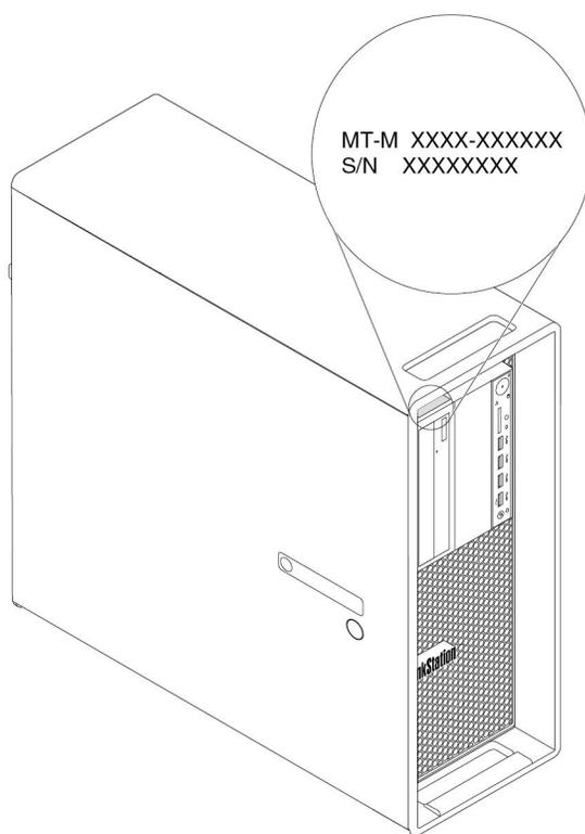
图 6. 机器类型和型号标签
