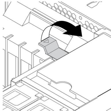
图 128. 打开正面风扇组合件中的固定栓
