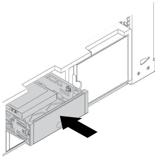
图 76. 安装类型 **2** 存储驱动器支架
