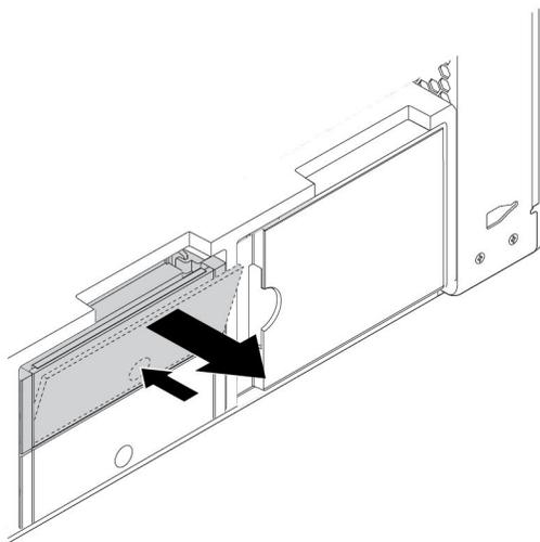
图 64. 卸下类型 **2** 存储驱动器支架
