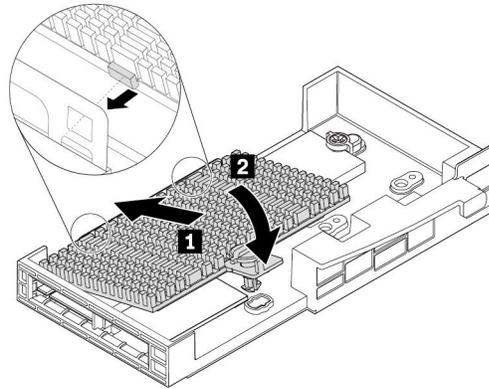
图 102. 将散热器安装在 M.2 固态硬盘固定器上
