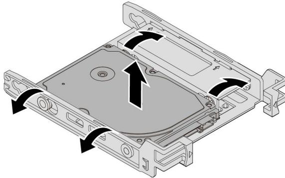
图 46. 从支架上卸下 2.5 英寸存储驱动器
