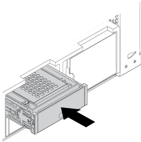
图 95. 安装类型 **2** 存储驱动器支架
