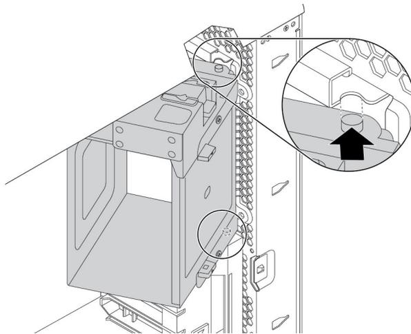
图 55. 将 Flex 托架支架放入机箱中
