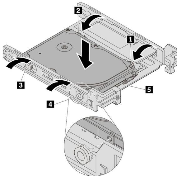
图 51. 将新的 2.5 英寸存储驱动器装入支架
