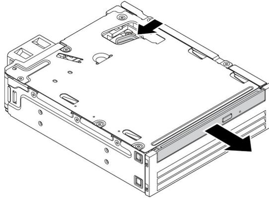
图 30. 从套件上卸下薄型光盘驱动器
