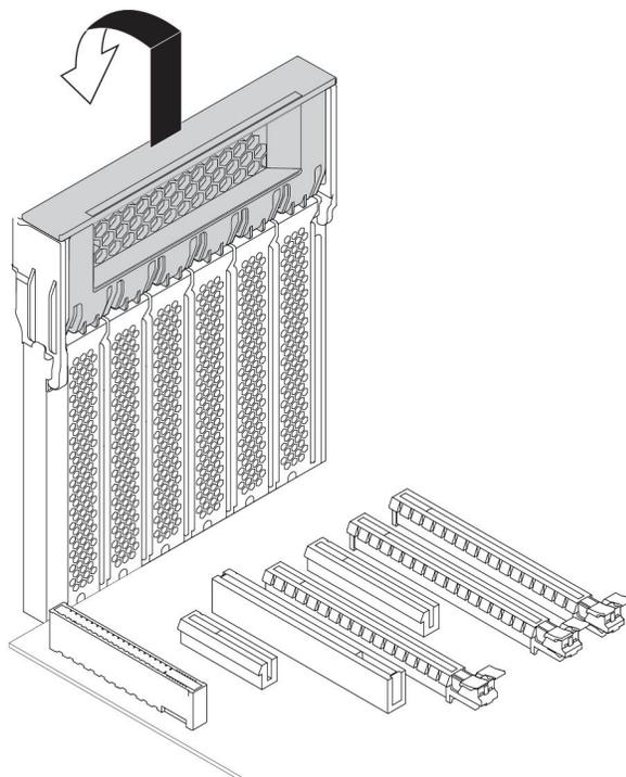
图 121. 打开 PCIe 卡栓
