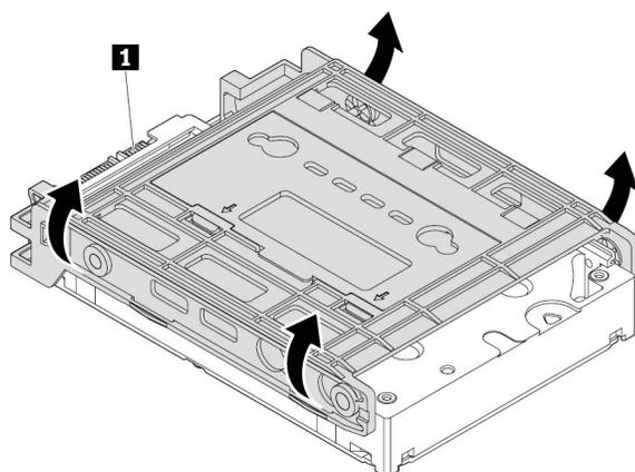
图 36. 从转换支架上卸下 3.5 英寸存储驱动器
