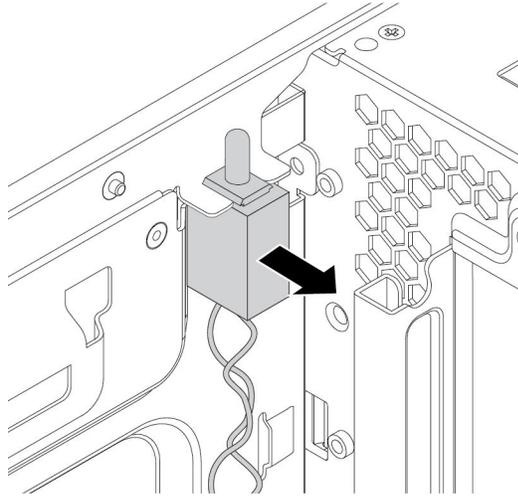
图 57. 卸下外盖存在感知开关
