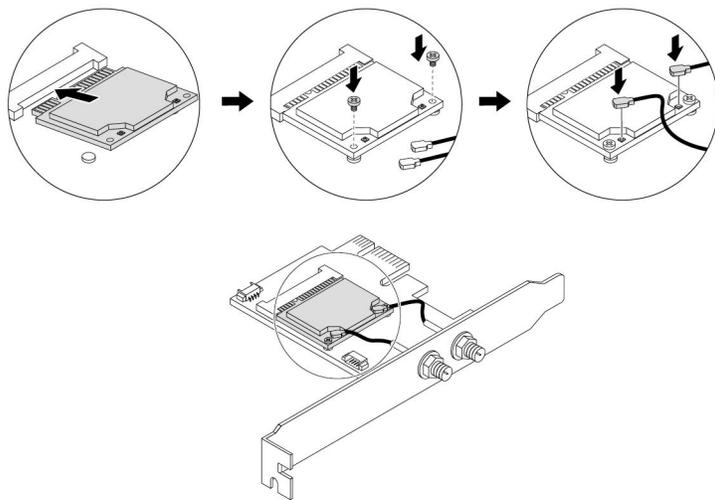
图 151. 安装 Wi-Fi 卡
