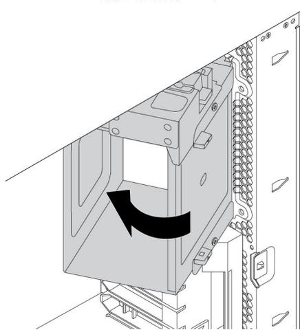
图 56. 安装 Flex 托架支架
