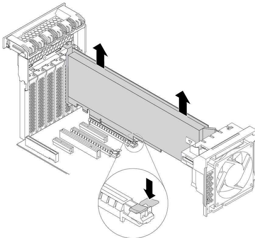
图 125. 卸下全长型 PCIe 卡
