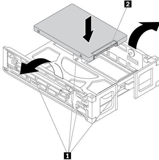
图 71. 将存储驱动器装入类型 **1** 支架中
