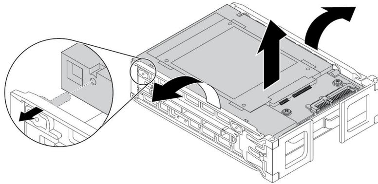
图 79. 从类型 **1** 支架上卸下转换装置
