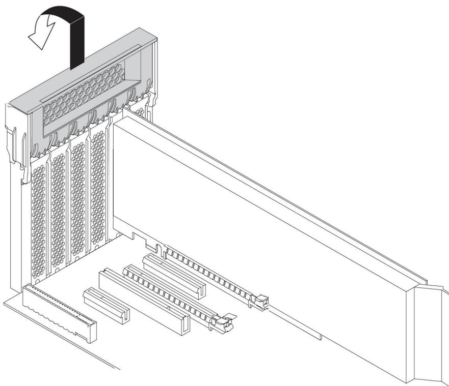
图 123. 打开 PCIe 卡栓
