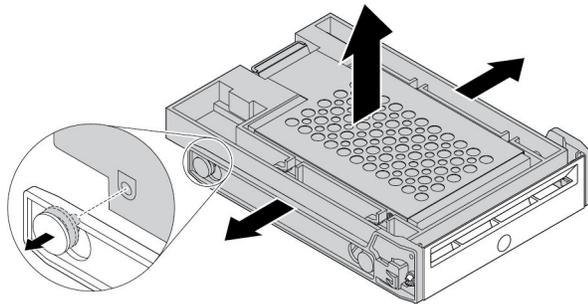
图 22. 从支架上卸下 2.5 英寸存储驱动器
