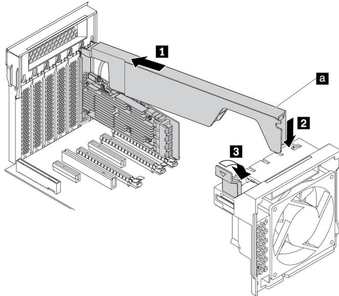
图 129. 安装超级电容模块
