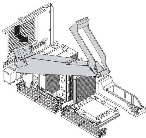
图 141. 安装内存挡风板的一端
