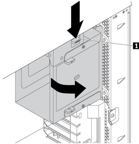
图 54. 卸下 Flex 托架支架
