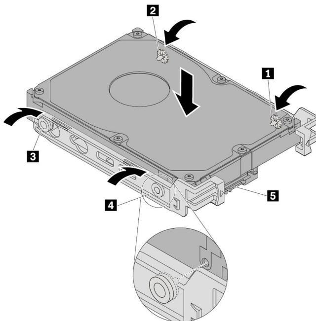
图 41. 将新的 3.5 英寸存储驱动器装入支架
