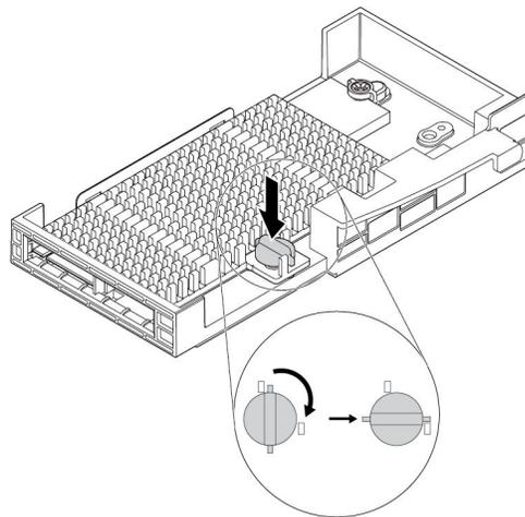
图 103. 将散热器固定到 M.2 固态硬盘固定器上
