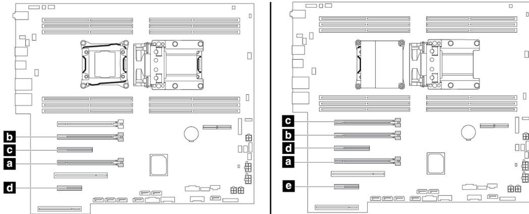
图 116. PCIe 卡安装顺序
