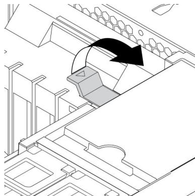
图 117. 打开正面风扇组合件中的固定栓
