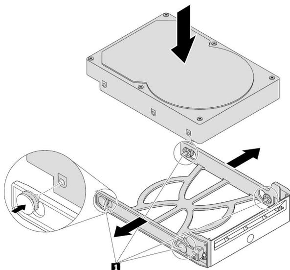
图 18. 将 3.5 英寸存储驱动器装入支架
