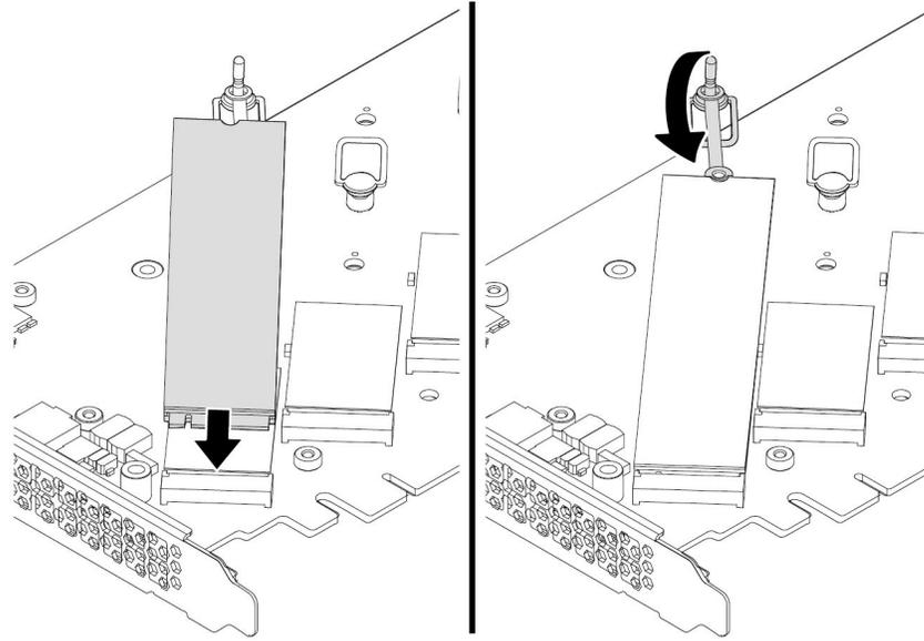
图 111. 安装 M.2 固态硬盘
