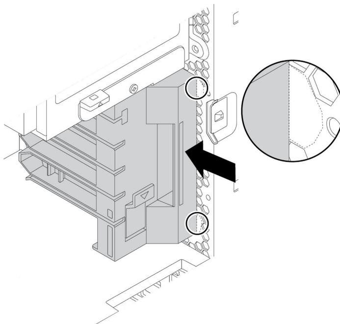
图 132. 确保正面风扇组合件已牢固就位
