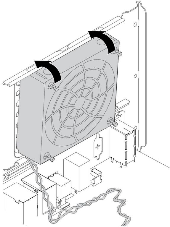
图 135. 安装背面风扇组合件
