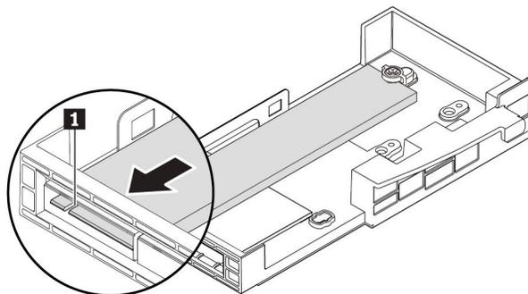
图 100. 安装 M.2 固态驱动器
