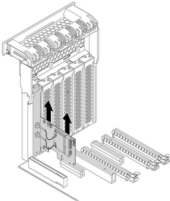
图 149. 卸下 Wi-Fi 适配器
