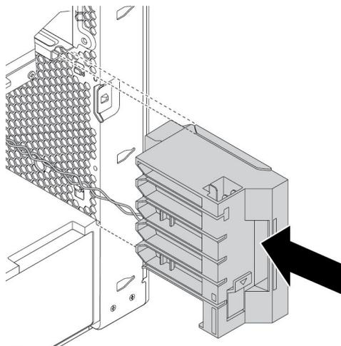
图 131. 安装正面风扇组合件
