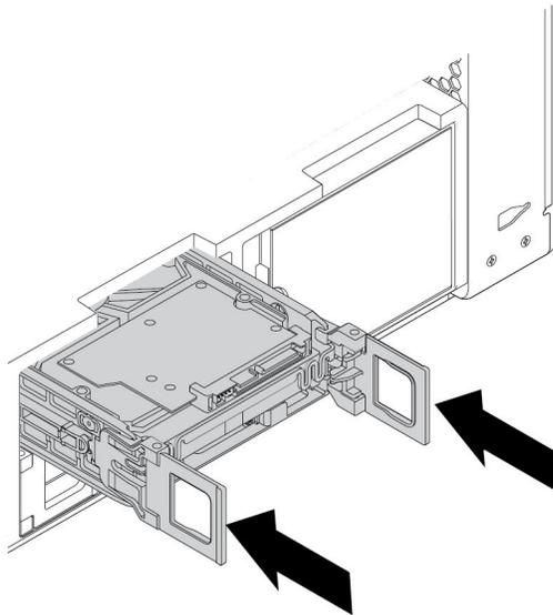
图 63. 安装类型 **1** 存储驱动器支架
