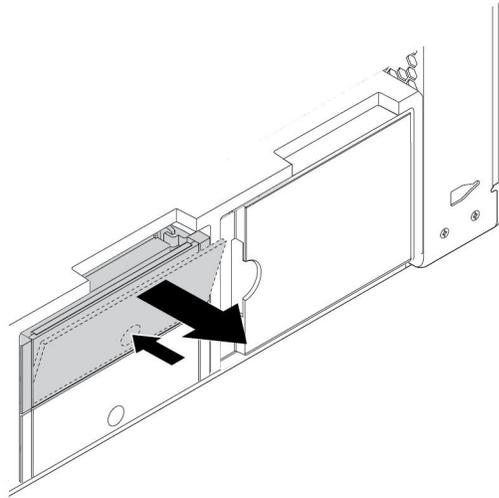
图 73. 卸下类型 **2** 存储驱动器支架
