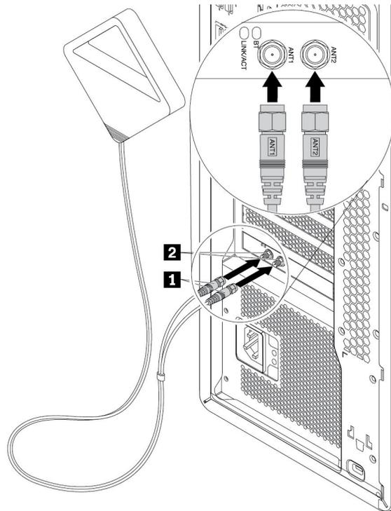
图 153. 安装 Wi-Fi 天线
