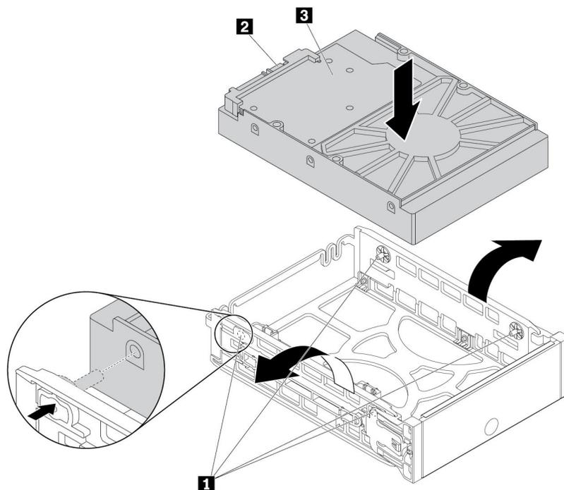
图 66. 将存储驱动器装入类型 **2** 支架中
