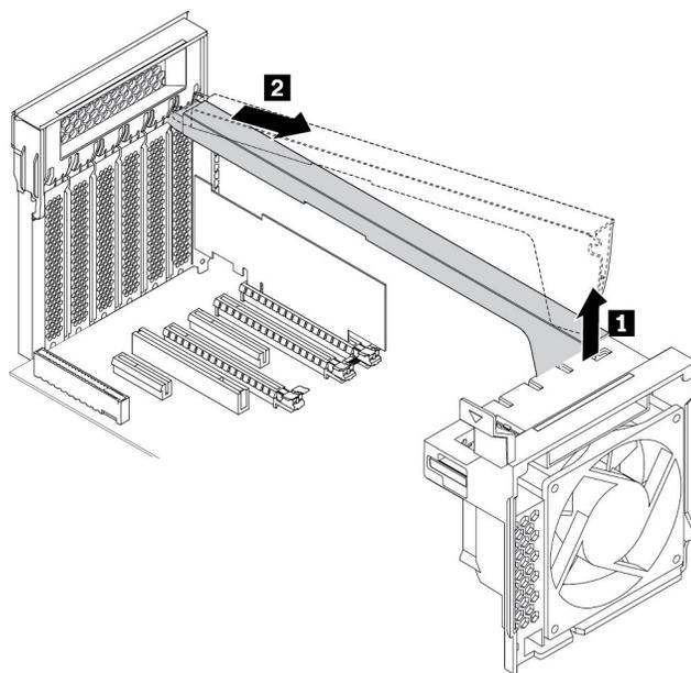
图 118. 卸下 PCIe 卡固定器
