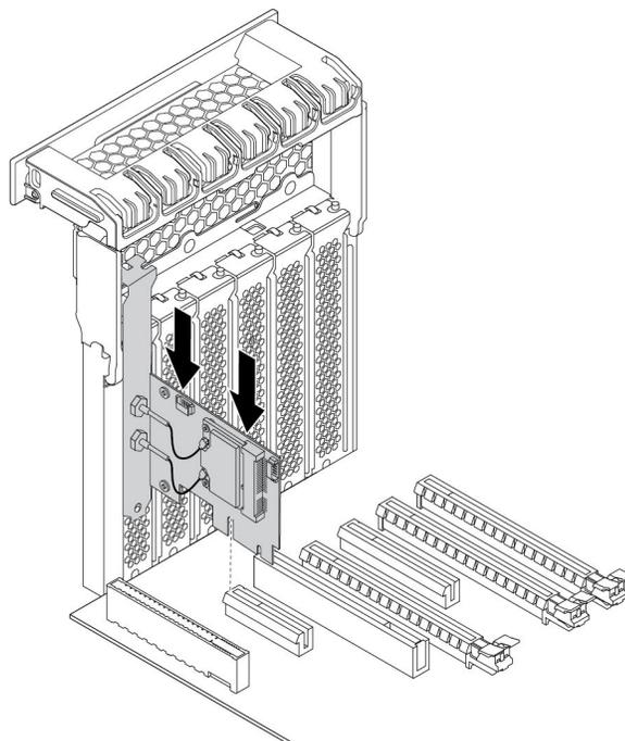
图 152. 安装 Wi-Fi 适配器
