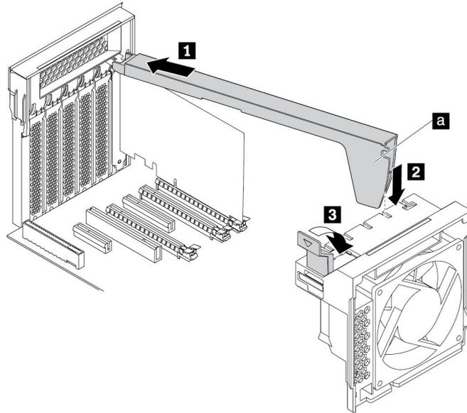
图 122. 安装 PCIe 卡固定器
