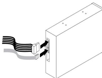
图 14. 将线缆连接到光盘驱动器
