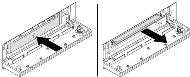
图 21. 从前置式存储机箱中卸下支架
