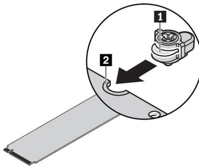
图 99. 将螺杆固定器插入 M.2 固态硬盘上
