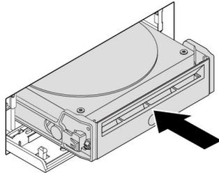
图 19. 将 3.5 英寸存储驱动器装入前置式存储机箱
