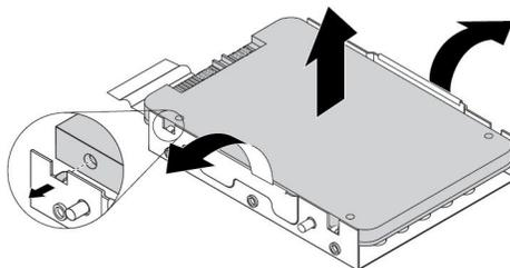
图 24. 从金属支架上卸下存储驱动器
