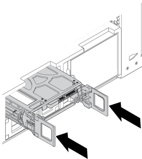
图 72. 安装类型 **1** 存储驱动器支架
