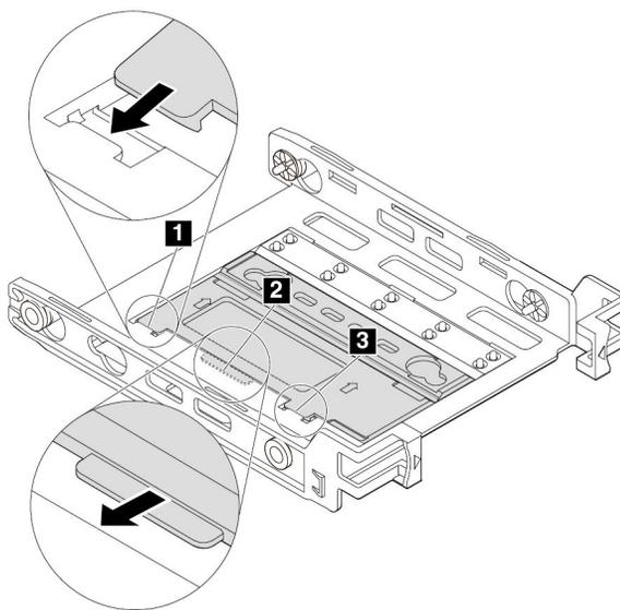
图 40. 将卡舌插入相应的插槽
