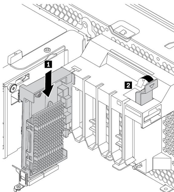
图 104. 安装 M.2 固态硬盘固定器
