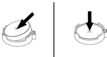
图 145. 安装纽扣电池
