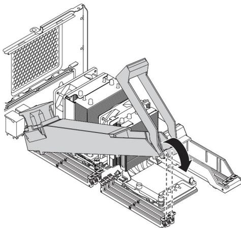
图 142. 向下旋转内存挡风板的另一端
