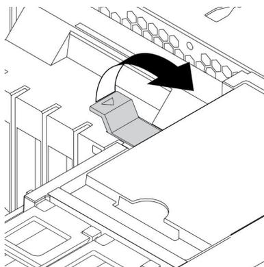
图 124. 打开正面风扇组合件中的固定栓
