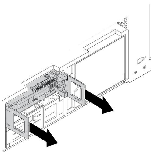
图 60. 卸下类型 **1** 存储驱动器支架
