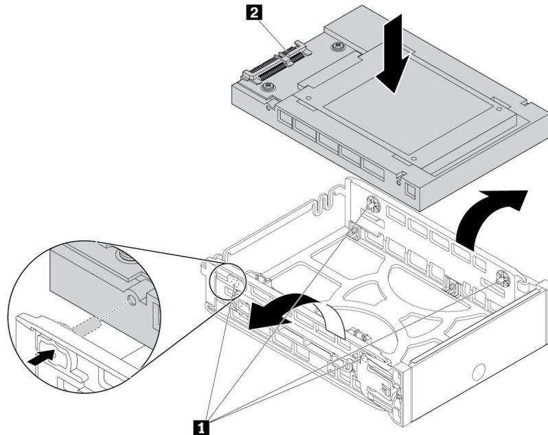
图 94. 将转换装置装入类型 **2** 支架中
