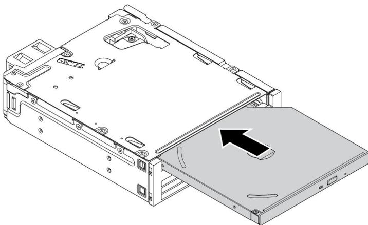
图 33. 将薄型光盘驱动器装入套件
