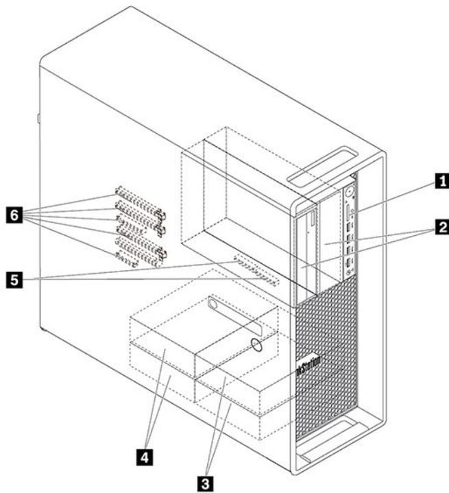
图 5. 存储驱动器托架位置
