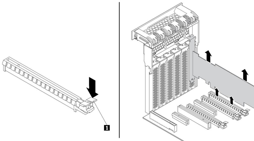
图 120. 卸下 PCIe 卡
