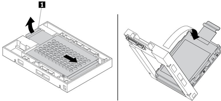
图 89. 从转换装置的塑料支架上卸下金属支架
