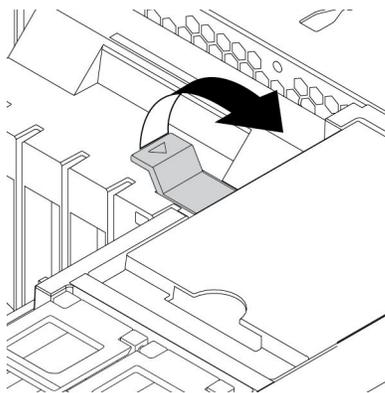
图 126. 打开正面风扇组合件中的固定栓
