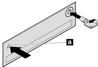
图 20. 打开前置式存储机箱外盖
