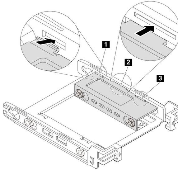
图 50. 将卡舌插入相应的插槽
