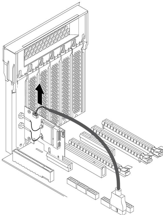
图 147. 断开蓝牙线缆的连接
