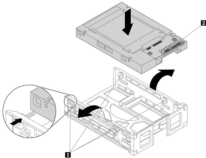
图 85. 将转换装置装入类型 **1** 支架中
