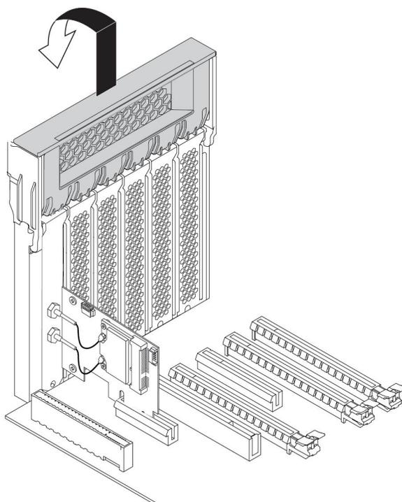
图 148. 打开 PCIe 卡栓
