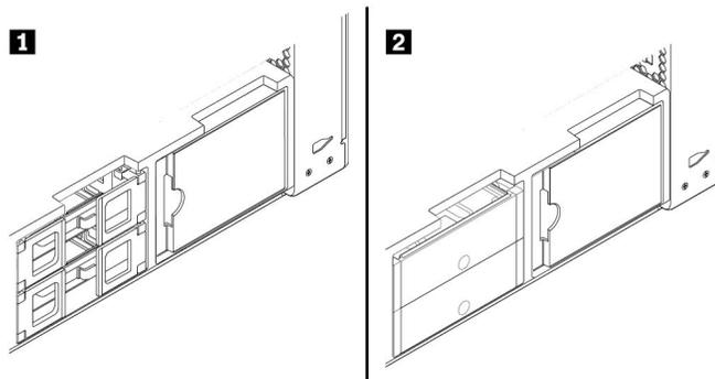
图 77. 两种存储驱动器支架类型
