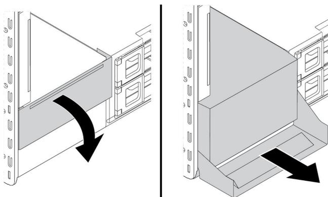
图 114. 卸下电源组合件
