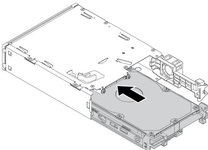
图 42. 将新的 3.5 英寸存储驱动器连同支架装入套件
