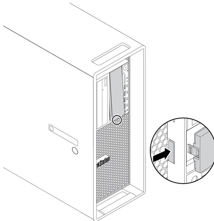
图 12. 卸下 Flex 托架中的塑料遮罩
