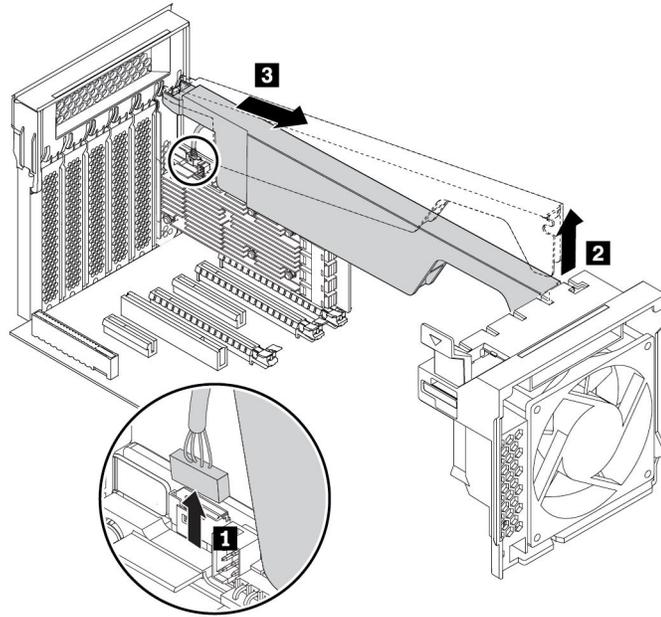
图 127. 卸下超级电容模块
