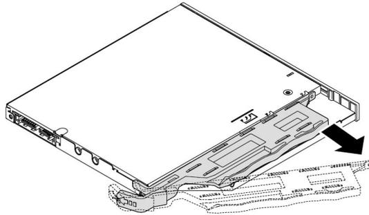
图 31. 从薄型光盘驱动器上卸下支架
