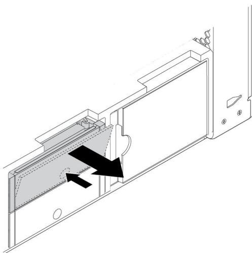
图 87. 卸下类型 **2** 存储驱动器支架
