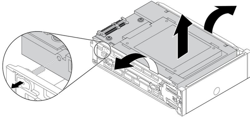
图 88. 从类型 **2** 支架上卸下转换装置
