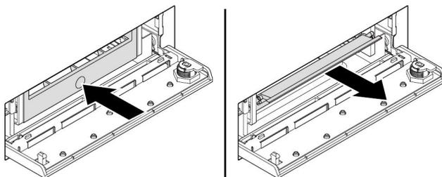
图 16. 从前置式存储机箱中卸下支架
