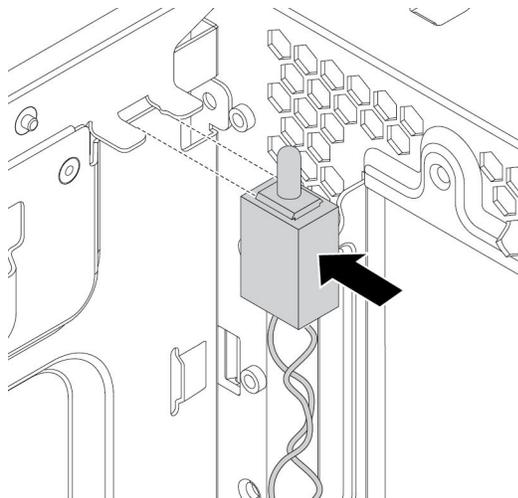
图 58. 安装外盖存在感知开关
