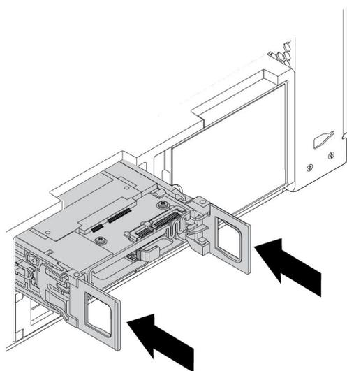
图 86. 安装类型 **1** 存储驱动器支架
