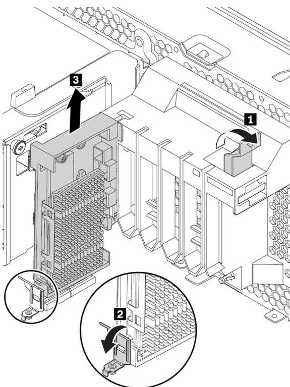
图 96. 卸下 M.2 固态硬盘固定器
