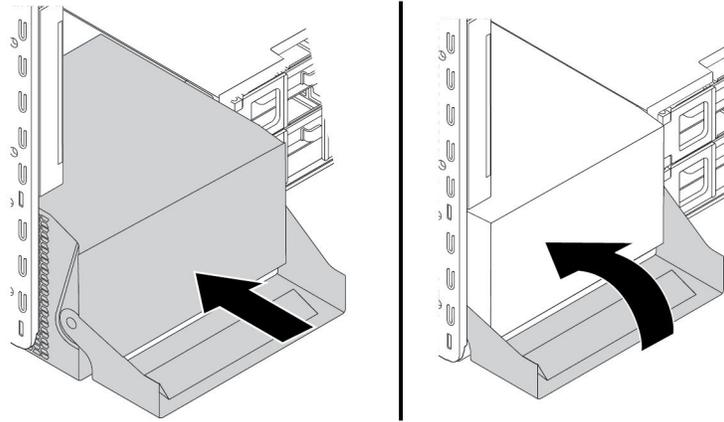
图 115. 安装电源组合件
