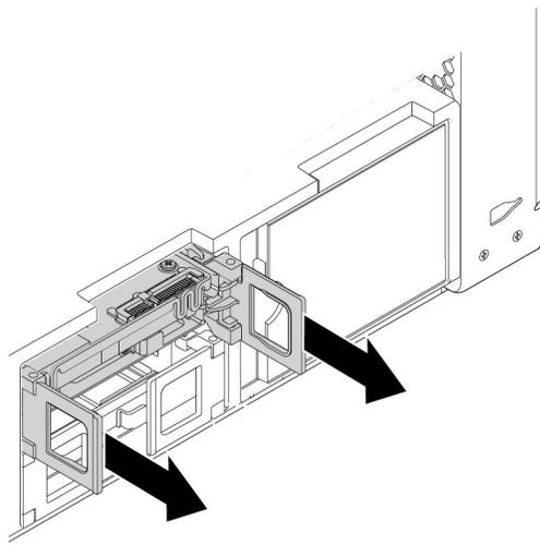
图 78. 卸下类型 **1** 存储驱动器支架
