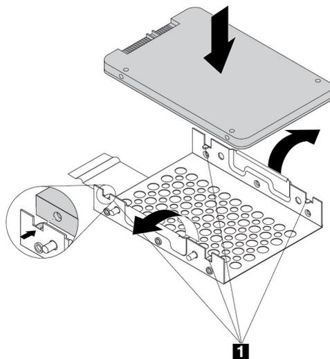
图 25. 将 2.5 英寸存储驱动器装入金属支架
