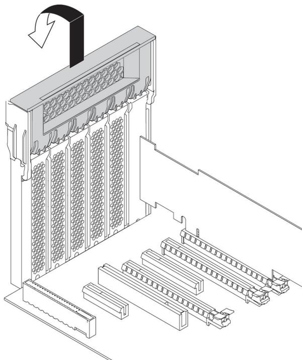
图 119. 打开 PCIe 卡栓
