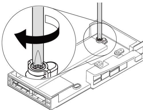
图 101. 固定 M.2 固态驱动器
