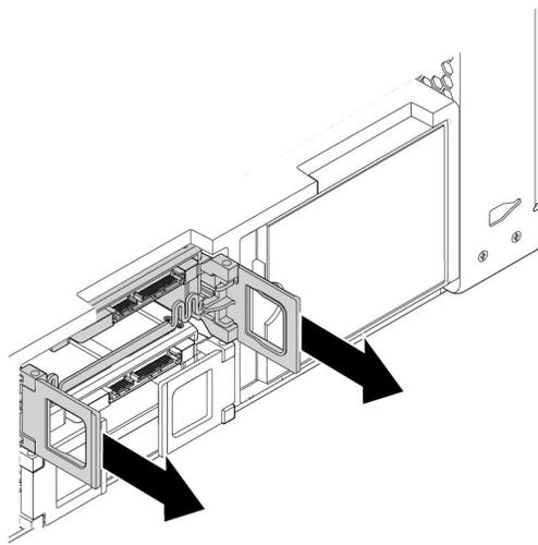
图 69. 卸下类型 **1** 存储驱动器支架
