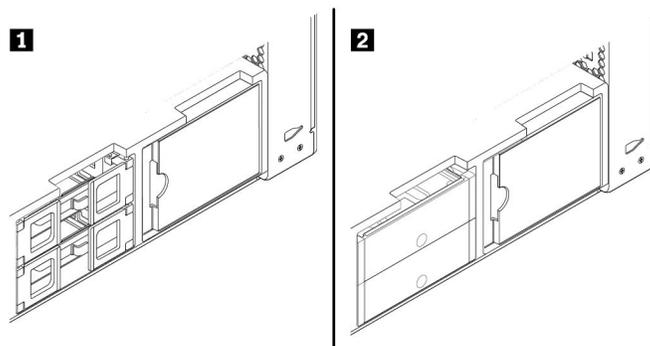
图 68. 两种存储驱动器支架类型
