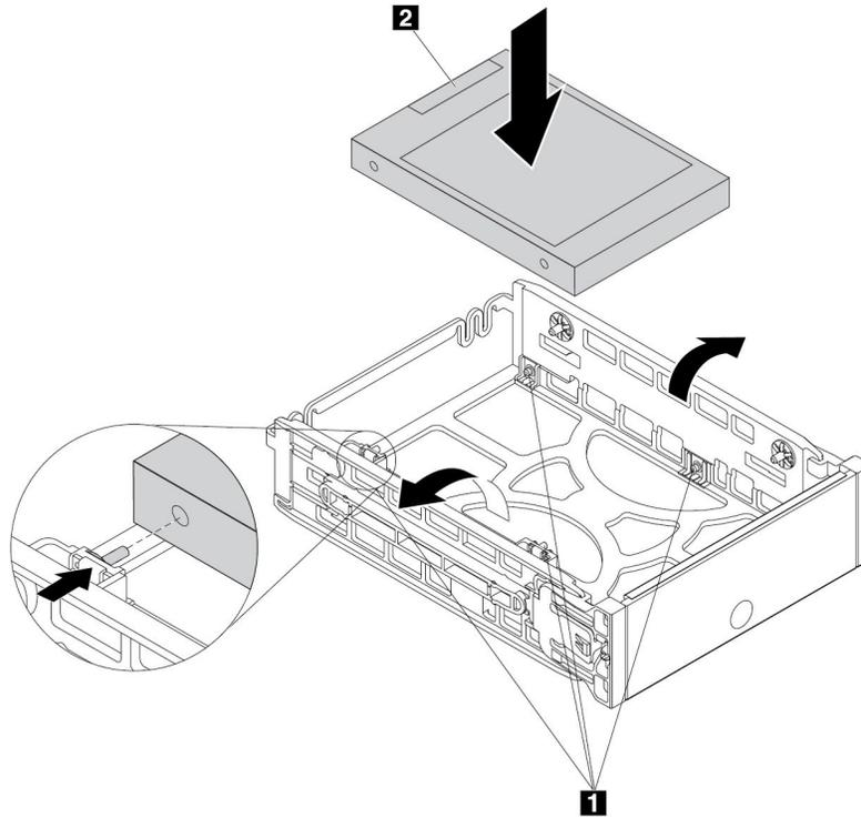
图 75. 将存储驱动器装入类型 **2** 支架中
