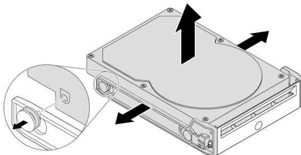
图 17. 从支架上卸下 3.5 英寸存储驱动器
