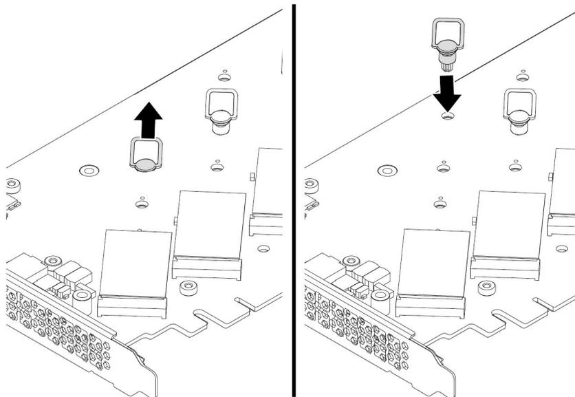
图 109. 调整固定栓在 PCIe 适配器上的位置
