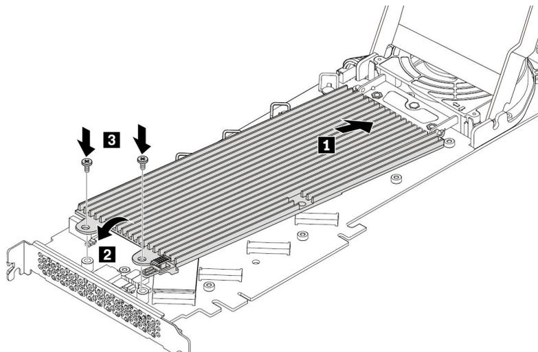
图 112. 将散热器安装在 PCIe 适配器上
