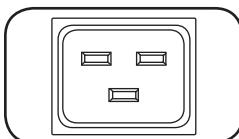
**Entrée d'alimentation IEC-320-C20 (PDUMNH20HV)** : L'entrée d'alimentation IEC se branche au cordon d'alimentation inclus ou à un cordon d'alimentation compatible fourni par l'utilisateur.
