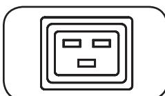
**Prises de sortie IEC-320-C19 (PDUMNH30HV et PDUMNH32HV)** : Ces prises distribuent une alimentation 208/230 V CA à l'équipement branché.
