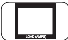
**Цифровой измеритель нагрузки (амперметр) (для мод. PDUMNH20HV):** цифровой измеритель нагрузки отображает значение нагрузки в амперах.
