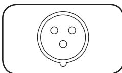
**Cordon d'alimentation d'entrée CA IEC 309P (PDUMNH32HV)** : Le cordon est attaché en permanence à la PDU et comporte une fiche 2P + E IEC 309P.
