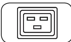
**Выходные розетки IEC-320-C19 (для мод. PDUMNH30HV и PDUMNH32HV):** в штатном режиме работы эти розетки распределяют мощность переменного тока напряжением 208/230 В между подключенными к ним элементами оборудования.
