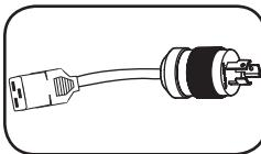
**Adaptador de Entrada de CA (PDUMNH20HV):** El adaptador convierte el cable de alimentación de entrada de CA a una clavija NEMA L6-20P. El soporte de retención incluido (no mostrado) asegura la conexión.
