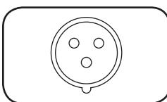
**Входной шнур питания переменного тока IEC 309P (для мод. PDUMNH32HV):** шнур прикреплен к PDU неразъемным способом и оснащен разъемом типа 2P + E IEC 309P.
