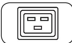
**Tomacorrientes de Salida IEC-320-C19 (PDUMNH30HV y PDUMNH32HV):** Estos tomacorrientes distribuyen energía de 208V / 230V CA al equipo conectado.
