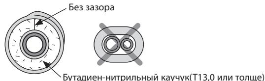
2. Обмотайте трубы и дренажный шланг изолентой, обращая особое внимание на то, чтобы чрезмерно не пережать изоляцию.
