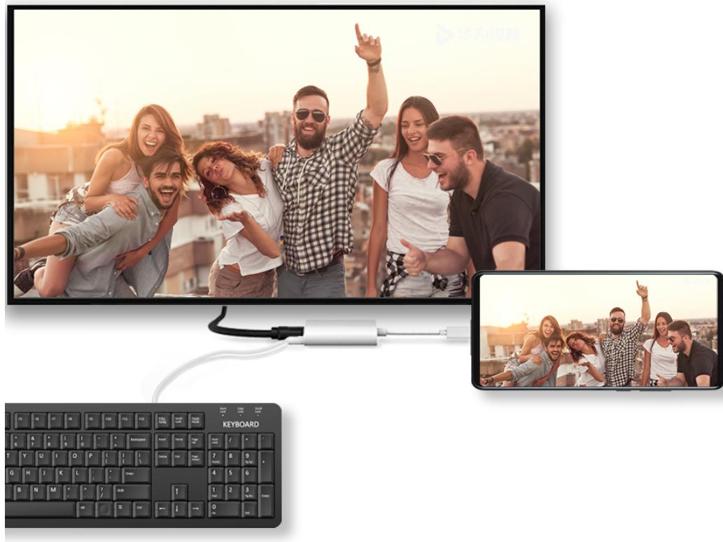
**3 在大屏端将输入信号源切换至转接线对应的 HDMI、DP 或 MiniDP 入口。**
