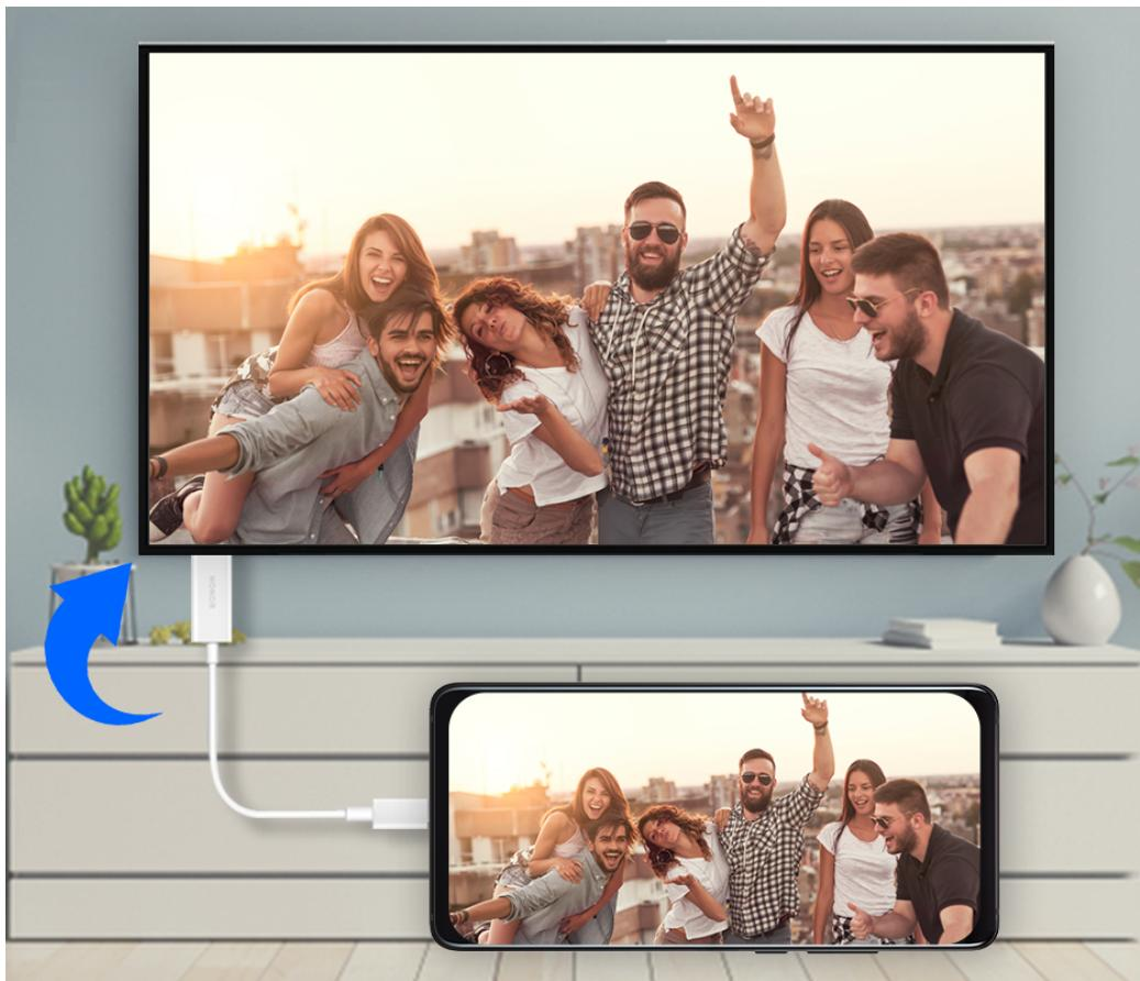
**3 在大屏端将输入信号源切换至转接线对应的 HDMI、DP 或 MiniDP 入口。**
