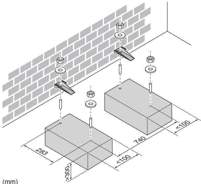
В любом случае обеспечьте зазор между блоками не менее 300 мм. Кроме того, убедитесь в том, что блок расположен как минимум на 100 мм выше предполагаемого максимального уровня поверхности снежного покрова.
