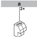
а Разъемы для соединительного кабеля между дополнительным блоком и блоком управления EKCB07CAV3.
