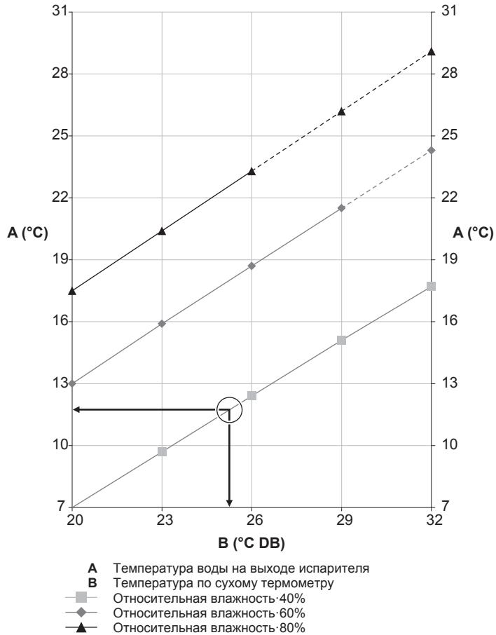
**Пример:** Дано: окружающая температура 25°C и относительная влажность 40%. Если температура воды на выходе испарителя <12°C, происходит конденсация.
