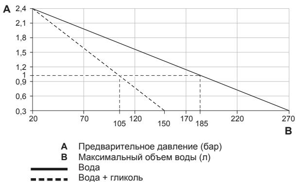
**Пример: максимальный объем воды и предварительное давление в расширительном баке**
