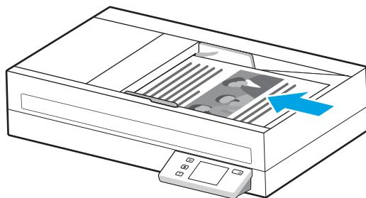
4. 根据文档的宽度，滑入纸张导板。如果纸张导板和文档两边之间有间隙，则扫描出的图像可能会歪斜。
