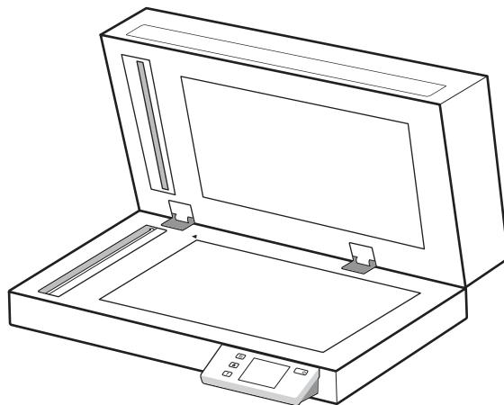
3. 使用蘸水的干净无绒软布或在干净的无绒软布上喷洒玻璃清洁剂，然后彻底擦拭平板扫描仪玻璃板。
