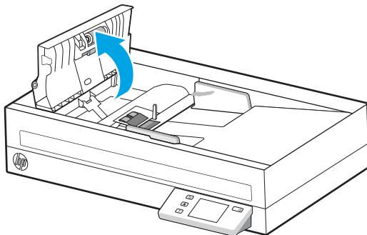
3. 按压分离垫/辊模块左侧的压片，然后向上提起并卸下。
