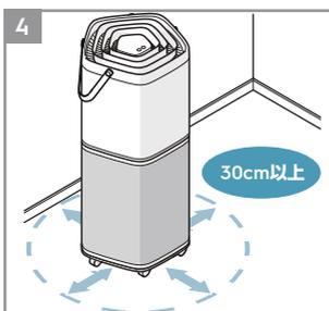
空気清浄機の前後左右に30cm以上のスペースを空けて設置します。
