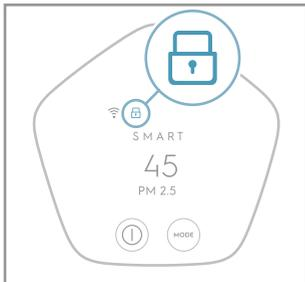
電源ボタンとモードボタンを同時に約4秒間長押しすると、チャイルドロックサインが点灯し、チャイルドロックがオンになります。チャイルドロックがオンのときは、コントロールパネルで操作ができなくなります。
