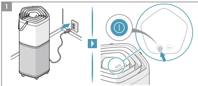
1 電源プラグをコンセントに差し込み、電源ボタンを押します。
