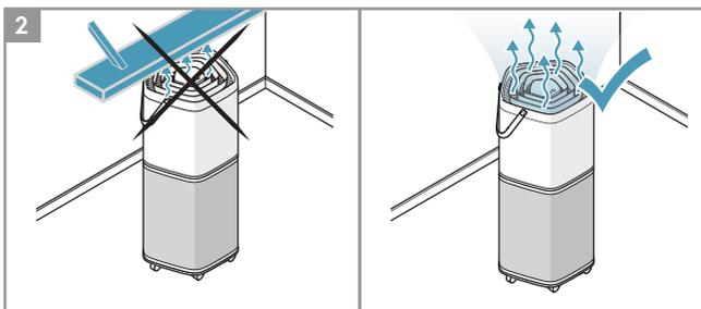
空気が流れが妨げられない場所に空気清浄機を設置します。
