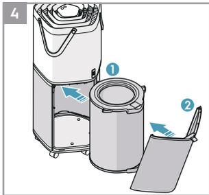
4 フィルターを本体に戻し、フィルタードアを取り付けます。
