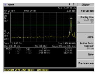
$\pi$  /4-DQPSK: Band Edge-High Channel
