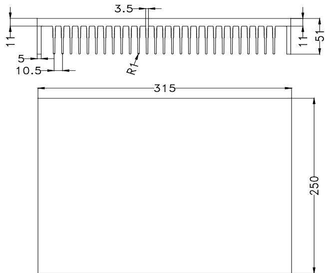
图一 Scheme for Heatsink 散热板尺寸图
