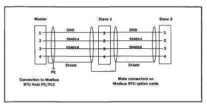
Fig. 11 RS485 wiring
