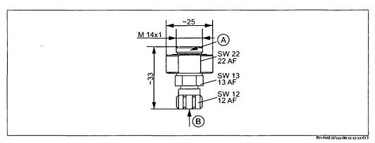
Abb. 14: Test adapter
