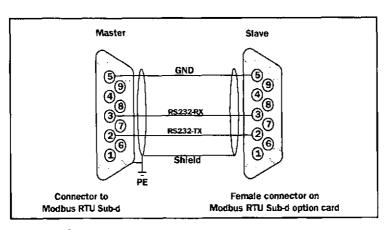
Fig. 15 RS232 wiring.
