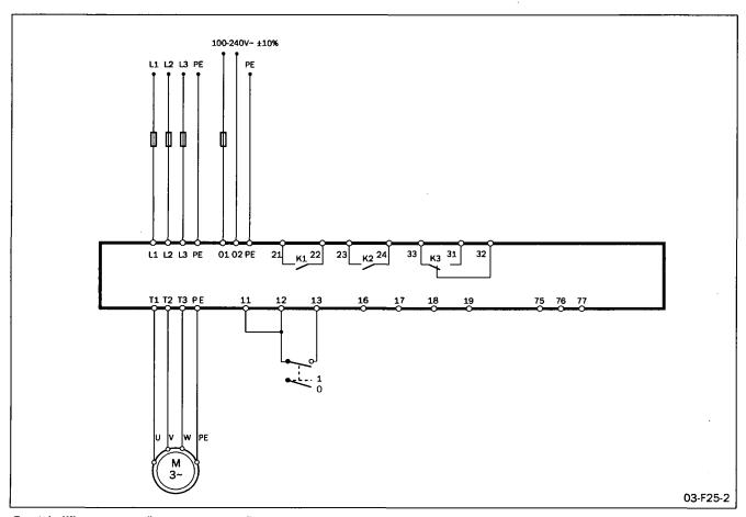
Fig. 24 Wiring circuit, "minimum wiring".
