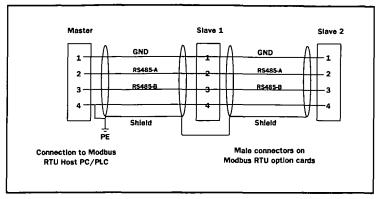
Fig. 8 RS485 wiring
