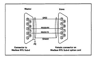
Fig. 21 RS232 wiring
