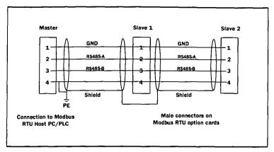
Fig. 17 RS485 wiring
