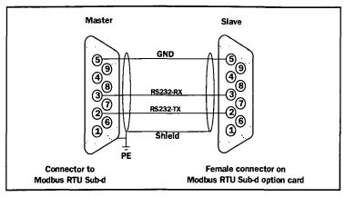
Fig. 12 RS232 wiring.
