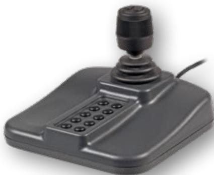
Der NVH-KEY1001 steuert IP-Dome-Kameras, die mit Sense verbunden sind, mit variabler Geschwindigkeit und voller Schwenk-, Neige- und Zoomfunktion. Dieser kompakte PTZ-Überwachungscontroller verfügt über einen Joystick mit zwei Tasten, drei Achsen und Hall-Effekt, 10 taktile Tasten und eine USB-Schnittstelle.
