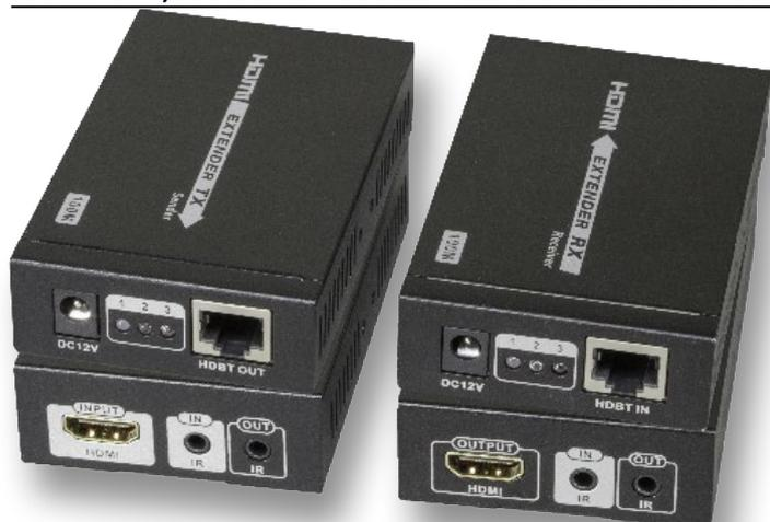
HDMI™ Extender auf Basis der HDBaseT Technologie
