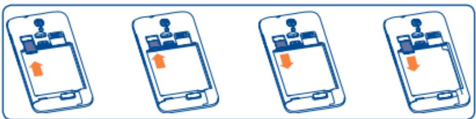
Для установки вставьте microSD-карту в слот контактами вниз. Для извлечения microSD-карты слегка надавите на неё, а затем извлеките её.
