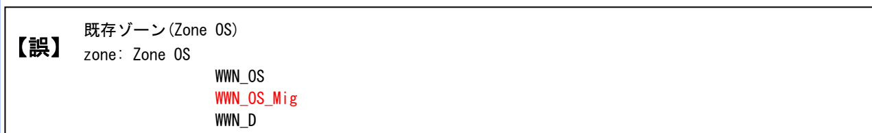
図 2-9 マイグレーション WWN を含むゾーニング設定の結果 (誤った例)
