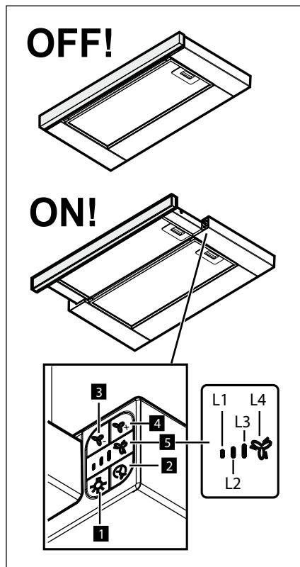
**1** Копче за вклучување/исклучување на осветлувањето
