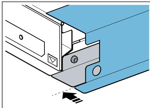
3. При дълбочина на шкафа (външен размер) от 330 mm до 360 mm окачете изравняването за дълбочина на канала.
