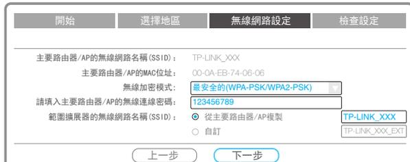
c. 填入主要路由器/AP的密碼，TL-WA850RE的SSID可以從主要路由器/AP複製 (例如：TP\_LINK\_XXX) 或另外自行設定 (例如：TP\_LINK\_XXX\_EXT)，但無線密碼不可變動。
