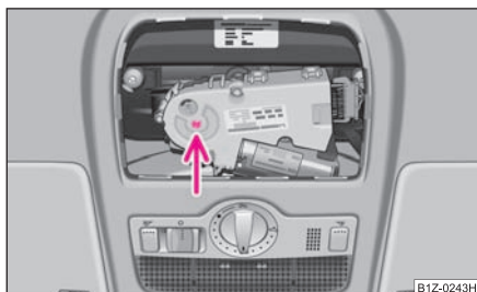
Изобр. 39 Вырез на потолке: Аварийное управление
