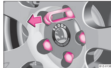
Изобр. 161 Снятие колпака болта крепления колеса
