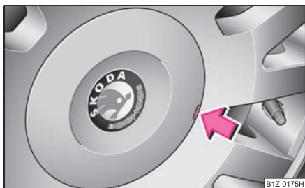
Изобр. 162 Снятие декоративного колпака колес из легкого сплава
