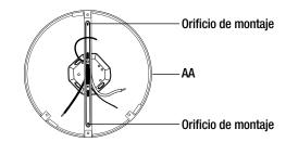
Retire el soporte (AA) e instale anclajes de plástico (DD) en los lugares marcados. Use una broca de 1/8 pulg. Para hacer un agujero e inserte un ancla de plástico (DD) en cada agujero golpeando suavemente.
