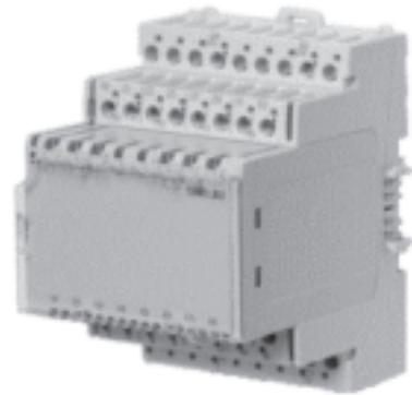
TX-I/O模块与控制器，电源或总线接口模块之间通过模块两端的金属片卡接而成，导轨式安装。相对于原来MBC的PTM系列模块在点数的密度分布上增加了一倍，大大降低了在箱体内部所需的空间。
