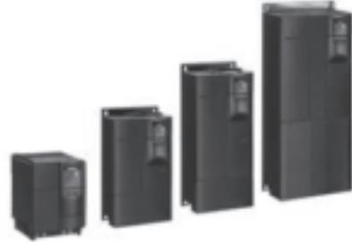
现场级变频器设备可采用MM4系列变频器，通过0~10 V或4~20 mA信号接到DDC控制器内。内置风机和泵类负载功能模块，基本满足楼宇控制的要求。这款变频器的功率范围从0.12 kW到250 kW，保护等级为IP20。基本机型带运行状态显示，也选择英文或中文操作面板进行参数操作。
