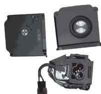
Вентиляторы и входной разъём электропитания
