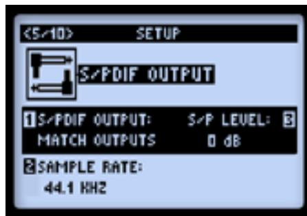
これらのオプションは、**S/PDIF OUT**ソケットへ送られた信号を設定するためのみに用意されています。コンピュータ・オーディオ・インターフェースまたはデジタル・ミキシング・コンソール等、他のデバイスのS/PDIFインプットへ接続する際に、この24ビット・デジタル・コネクションを使用します。
