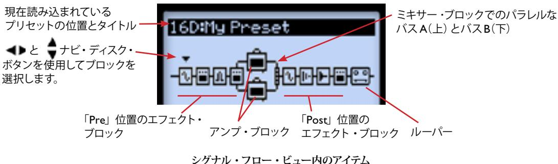
各プリセットのシグナル・フロー構造は、アンプ&エフェクト・ブロックを置くことの可能な、以下の3つのメイン・セクションで構成されています：プリ、ポスト、パラレルなバスA&B。
