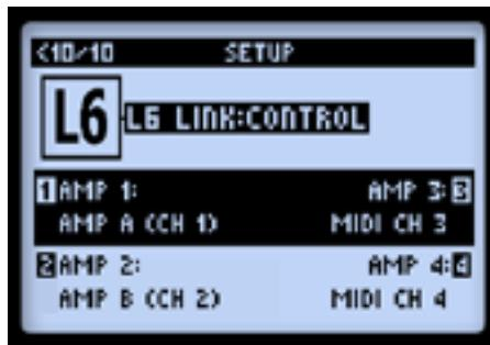
これらのオプションにより、接続した最大4台までのLine 6 DT50またはDT25アンプがPOD HD500X Ampモデル&セッティングにどのように追従するのかを設定することができます。DT50アンプ1～4に接続したL6 LINKに対して、パラメーター1～4がそれぞれ対応します。
