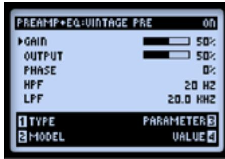
これは Requisite® Y7 ヴィンテージ・チューブ・マイク・プリアンプに基づいた\* ヴィンテージのモノ・チューブ・マイク・プリアンプのモデルで、マイク・ソース・インプットや Variax アコースティック・ギターで使用するのに最高なだけではなく、ベースやギター・アンプと共に使用することで、シグナル・パスのどの位置に入れても心地良いチューブの暖かさを得ることができます。
