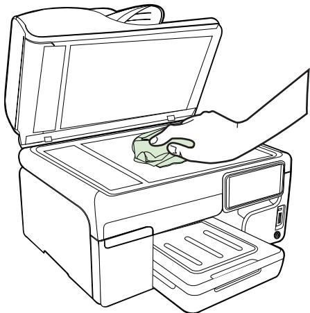
△ **ข้อควรระวัง** ใช้น้ำยาทำความสะอาดกระจุทำความสะอาดกระจุสแกนเนอร์เท่านั้น หลีกเลี่ยงน้ำยาทำความสะอาดที่มีส่วนผสมของสารกัดกร่อน อะซีโตน เบนซิน และสารบอนเตตราคลอไรด์ สารเหล่านี้จะก่อให้เกิดความเสียหายกับกระจุสแกนเนอร์ หลีกเลี่ยงการใช้เอลกออล์กอิโซไซโพรพิล เนื่องจากจะถึงร้าวรอยไว้บนกระจุได้
