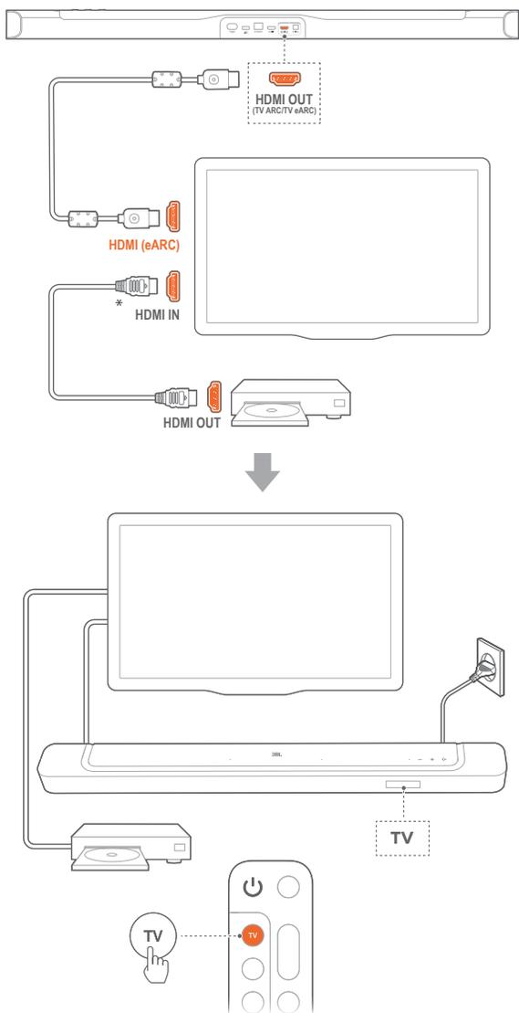
1. Conecte a soundbar com o conector **HDMI IN (eARC)** na sua TV usando cabo HDMI fornecido.
