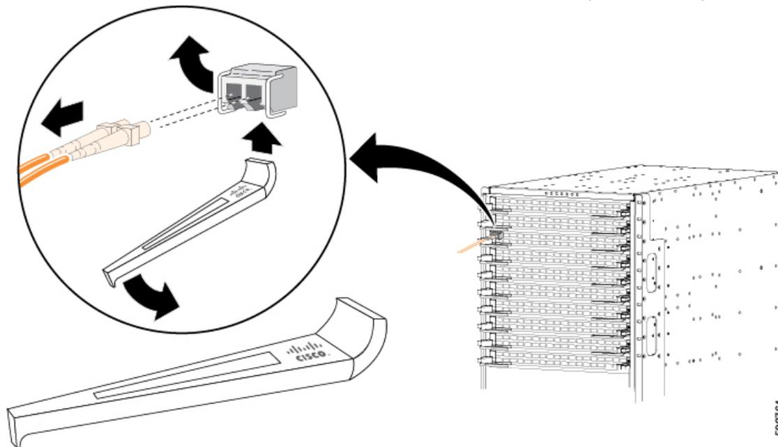
**Step 3** 光学抽出ツールの幅狭な終端を使用して、トランシーバ モジュールを注意して取り外します (次の図を参照)。
